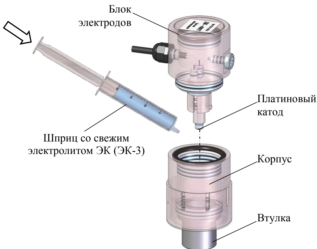
Рисунок 2.6 – Заливка электролита в датчик ДК-409Т, ДК-409ТМ
