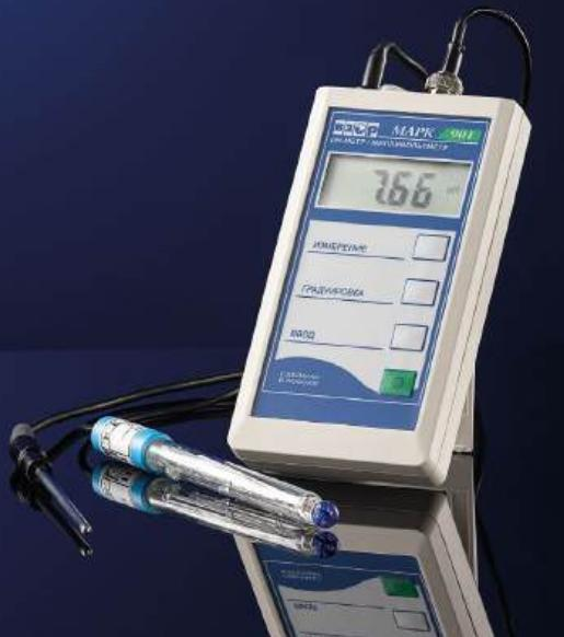
**Измерение активности ионов водорода (рН, рН<sub>25</sub>), ОВП, ЭДС и температуры водных сред.**
