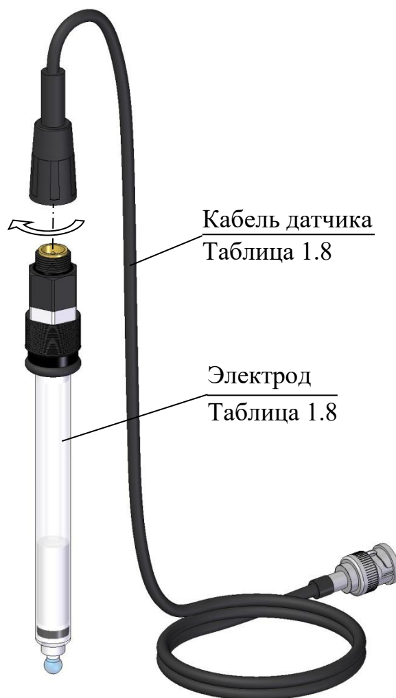
Рисунок 1.9 – Подключение кабеля датчика к комбинированным электродам
