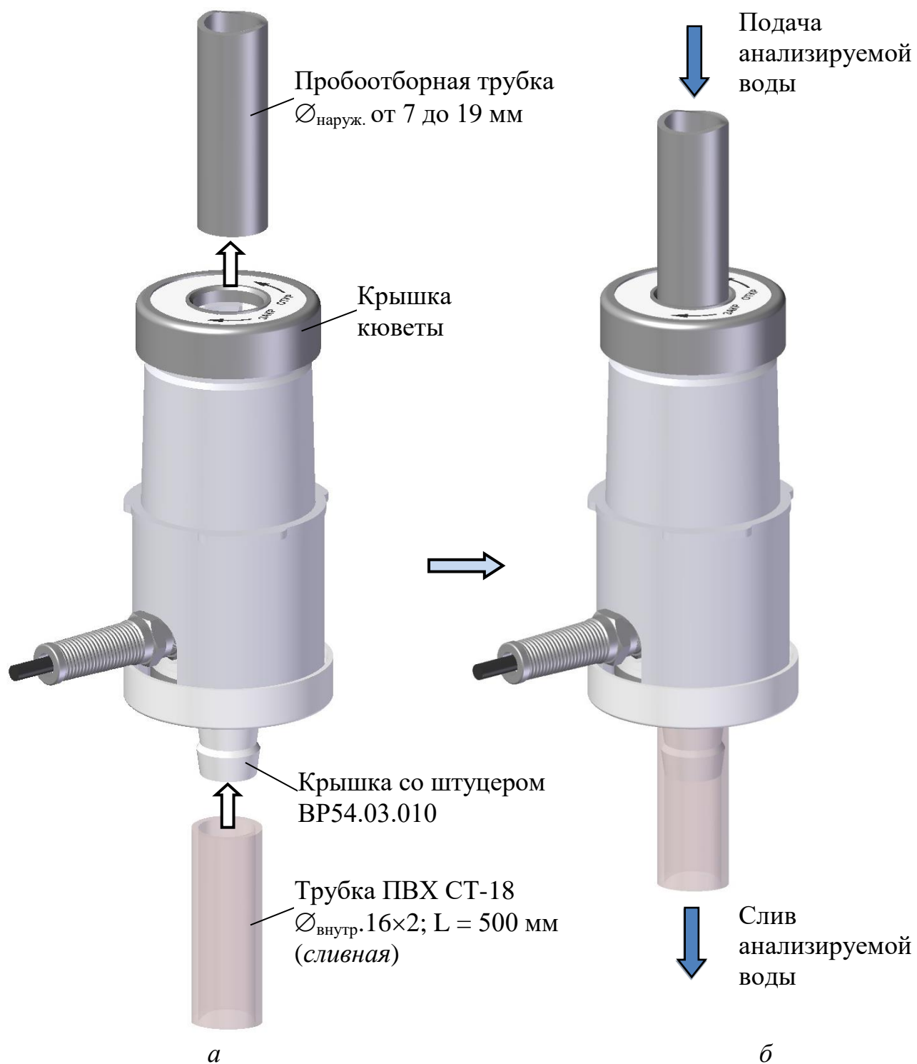
Рисунок 2.8 – Крепление кюветы на пробоотборной трубке с наружным диаметром от 7 до 19 мм
