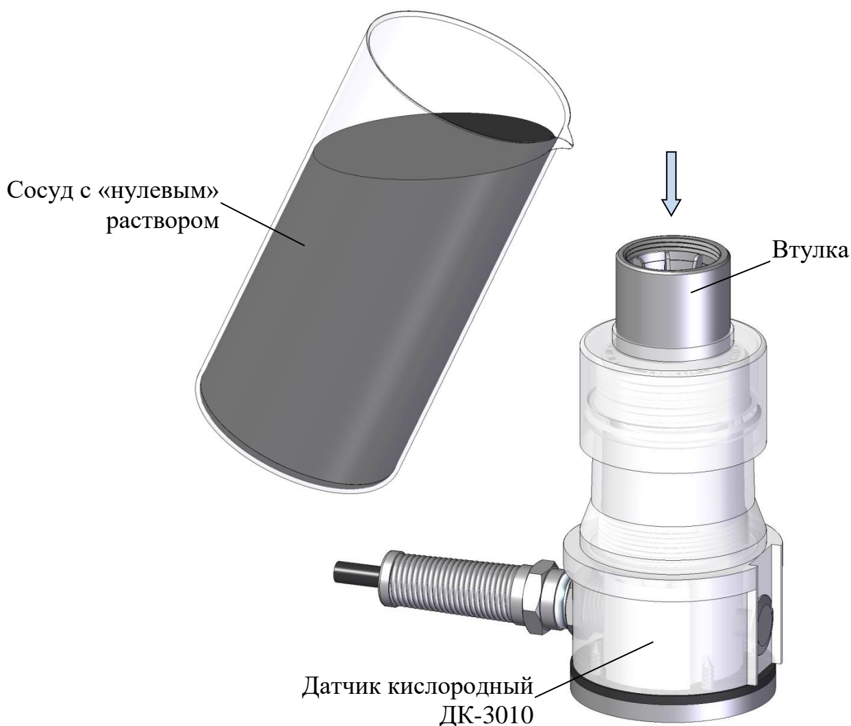
Рисунок 2.2 – Проверка показаний в «нулевом» растворе
