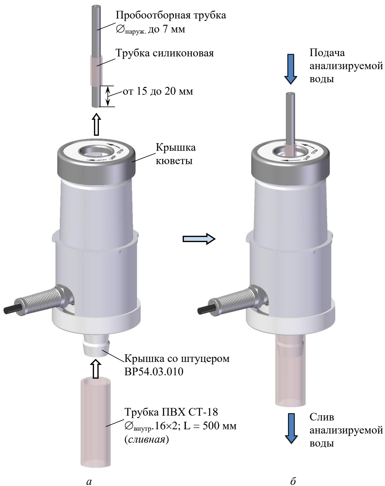
Рисунок 2.9 – Крепление кюветы на пробоотборной трубке с наружным диаметром до 7 мм
