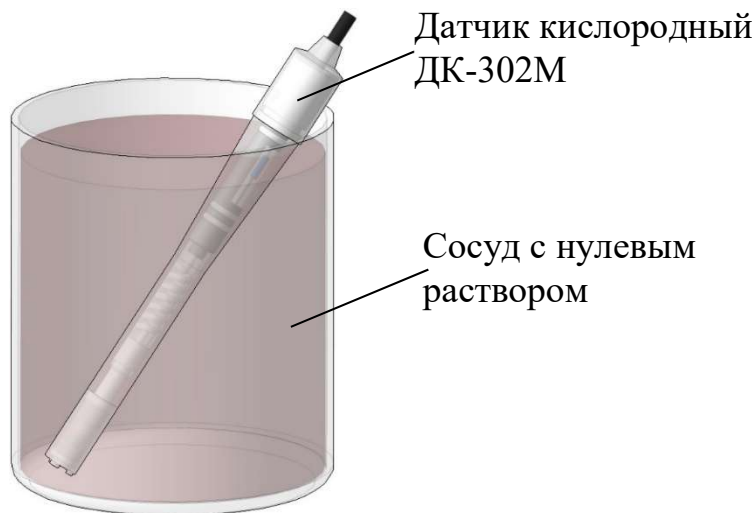
Рисунок 2.11 – Проверка показаний в «нулевом» растворе
