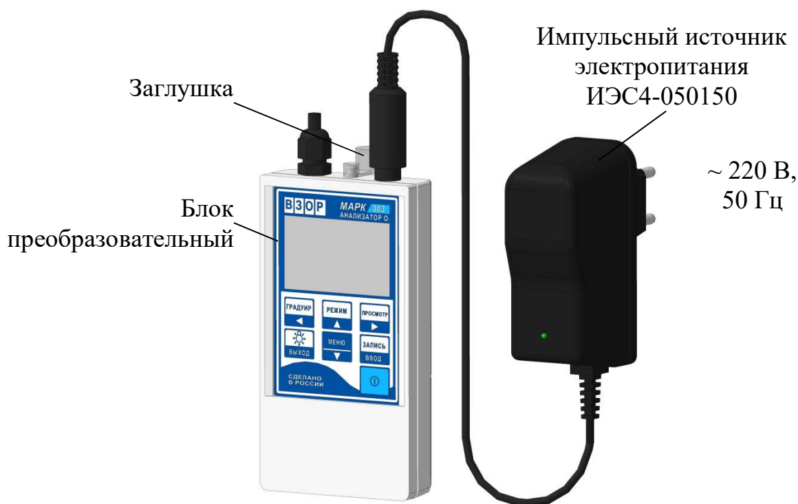
Рисунок 3.2 – Зарядка аккумуляторных батарей
