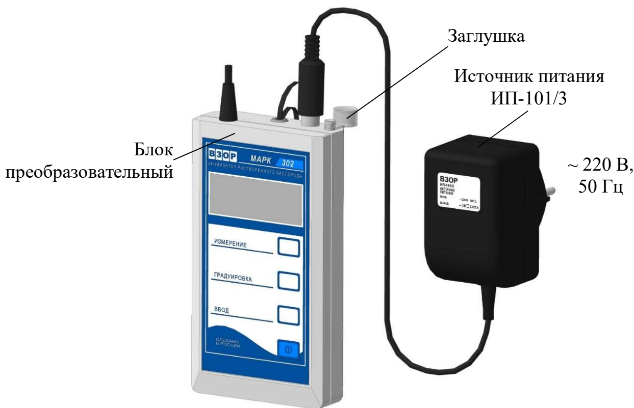
Рисунок 3.2 – Зарядка аккумуляторных батарей
