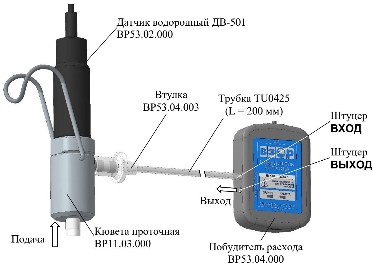
Рисунок 2.7–Проведение измерений с использованием побудителя расхода BP53.04.000
