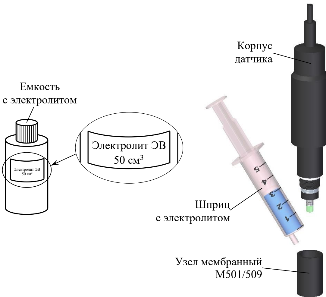
Рисунок 2.2 – Заполнение датчика электролитом
