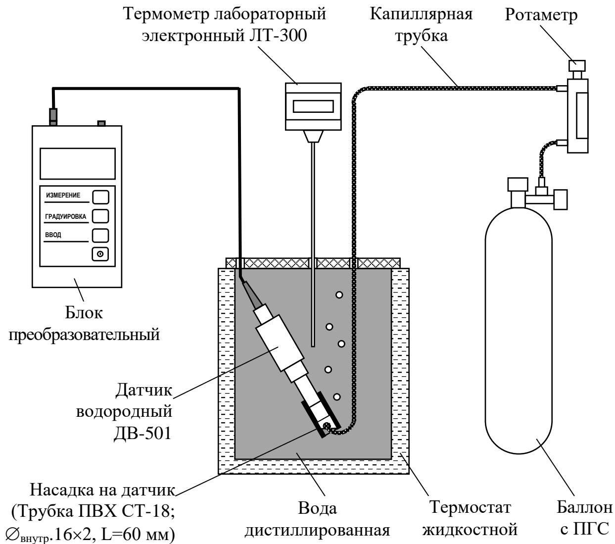
Рисунок А.10.2 – Установка для определения основной абсолютной погрешности анализатора при измерении КРВ и объемной доли водорода
