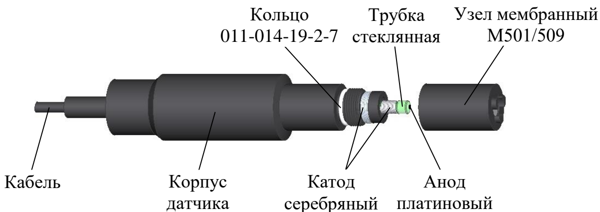
Рисунок 1.2 – Датчик водородный ДВ-501
