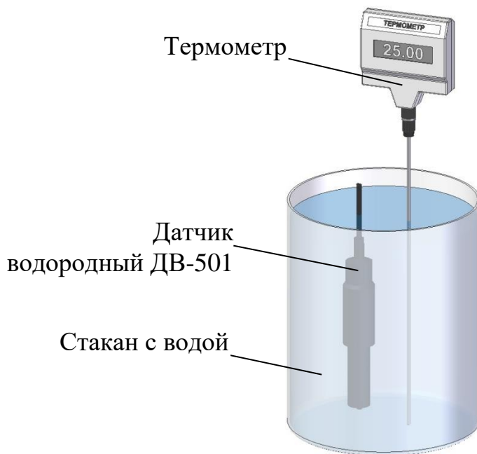
Рисунок 3.3 – Проверка показаний по температуре
