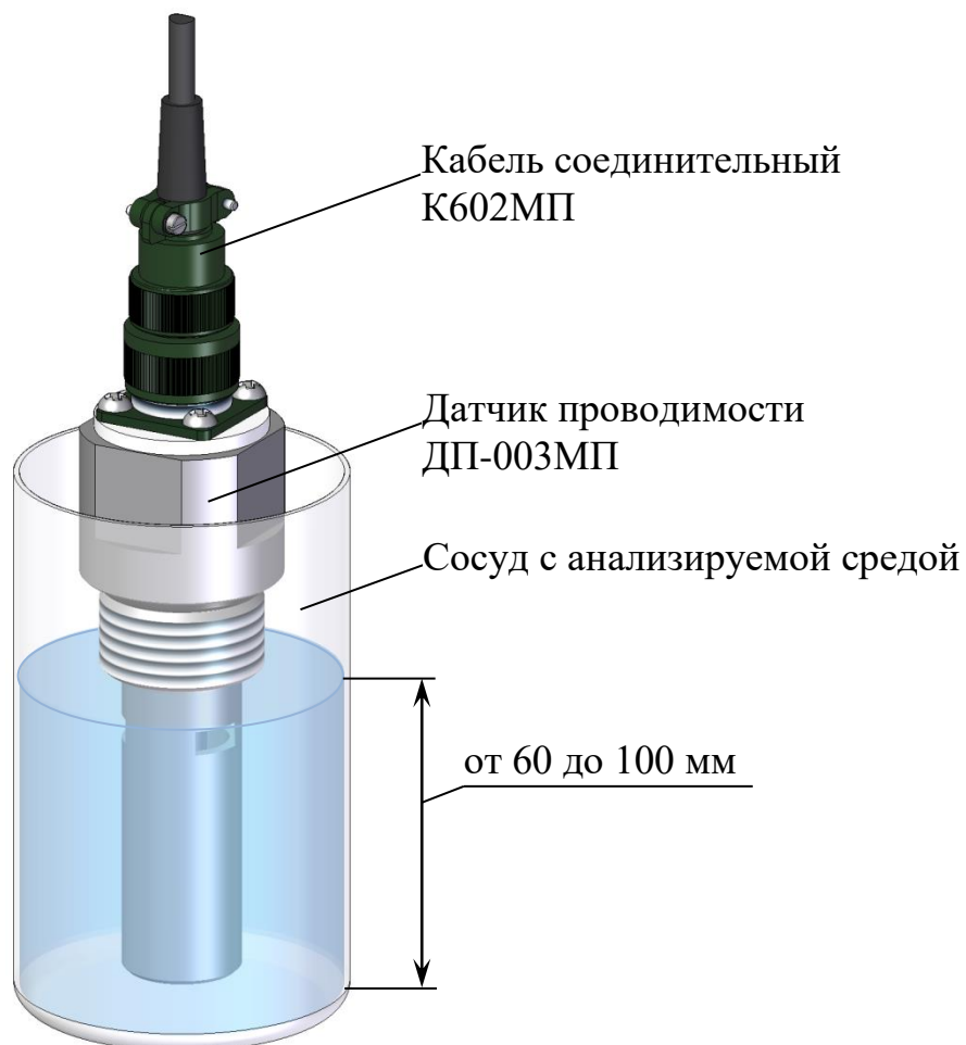
Рисунок 2.8 – Расположение датчика проводимости ДП-003МП в сосуде
