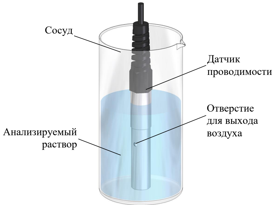
Рисунок 2.3 – Проведение измерений погружным методом
