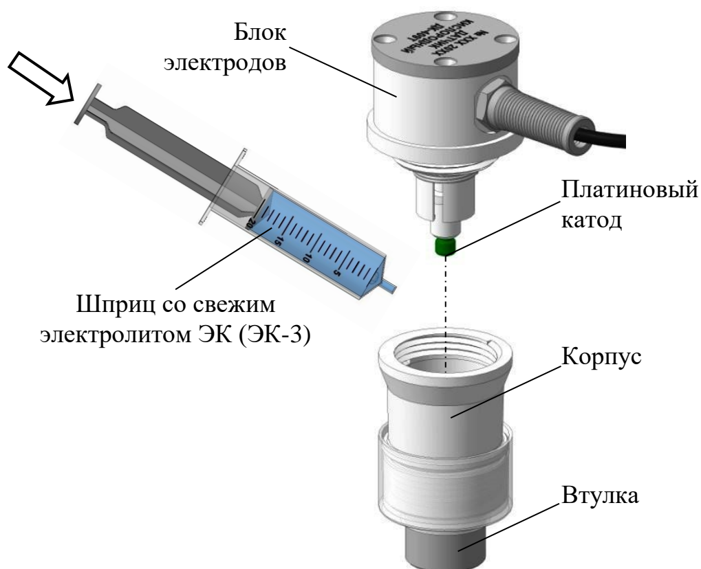
Рисунок 2.7 – Заливка электролита в датчик ДК-409Т, ДК-409ТМ
