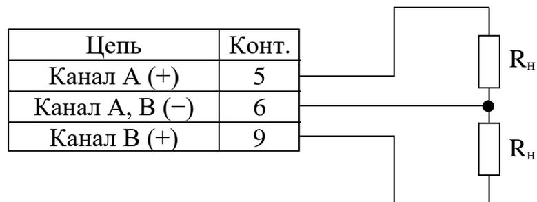
Рисунок 2.5 – Схема подключения внешней нагрузки к контактам разъема «ТОКОВЫЙ ВЫХОД»
