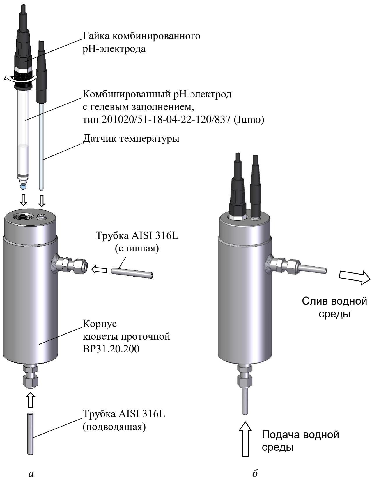
Рисунок 2.9 – Установка комбинированного pH-электрода и датчика температуры (на примере исполнения кюветы проточной BP31.20.200)
