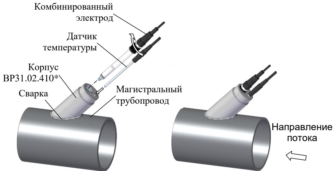
*a – Установка комбинированного электрода и датчика температуры в магистральный трубопровод*
