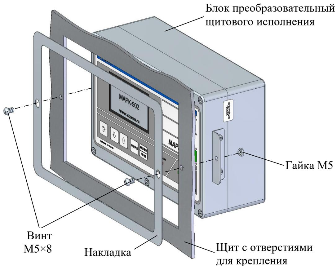
Рисунок 2.2 – Установка блока преобразовательного щитового исполнения
