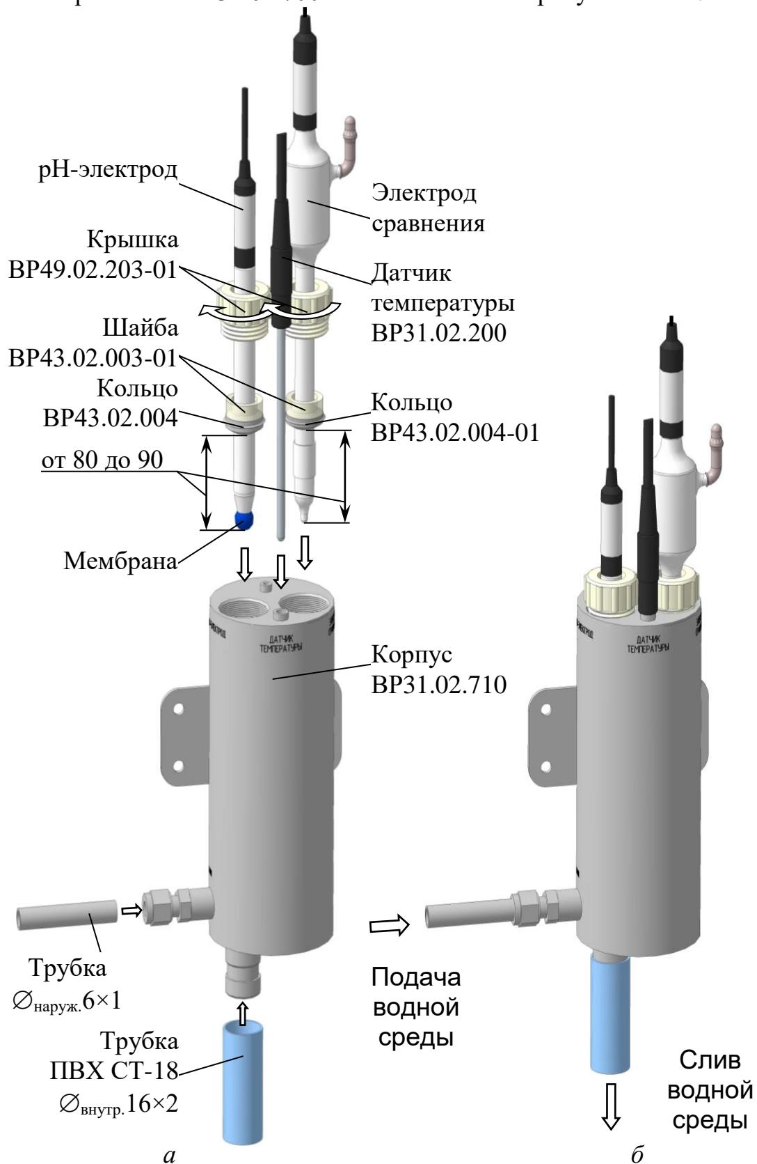
Рисунок 2.11 – Установка раздельной пары электродов и датчика температуры (на примере исполнения кюветы проточной BP31.02.700)
