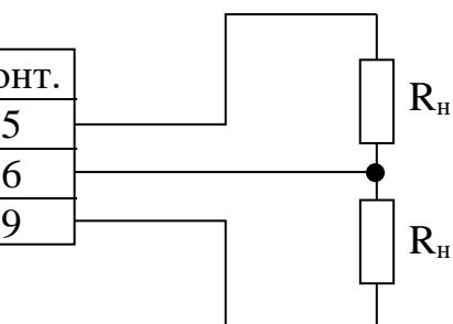
Рисунок 2.5 – Схема подключения внешней нагрузки
