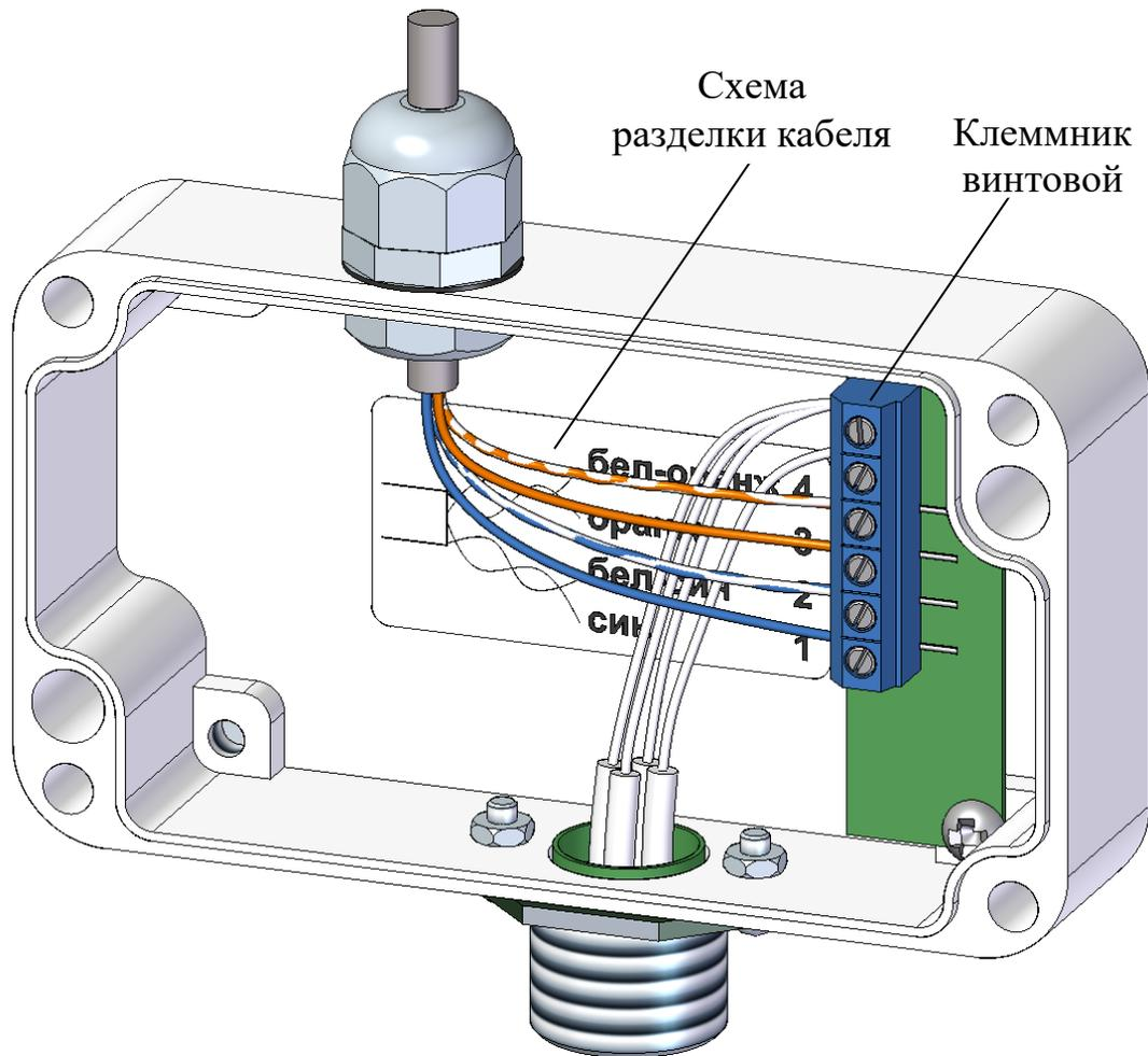
Рисунок 2.15 – Коробка клеммная (вид без передней панели)
