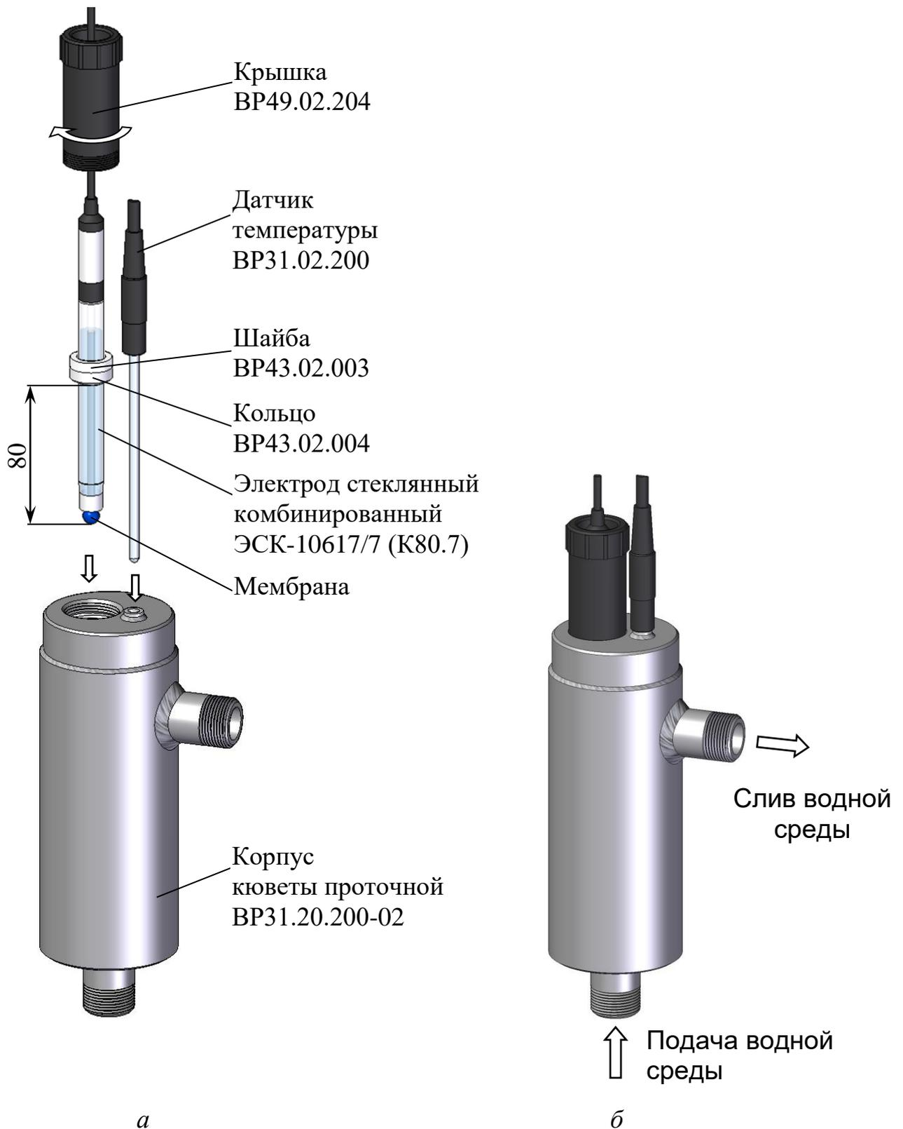
Рисунок 2.10 – Установка электрода стеклянного комбинированного и датчика температуры (на примере исполнения кюветы проточной ВР31.20.200-02)
