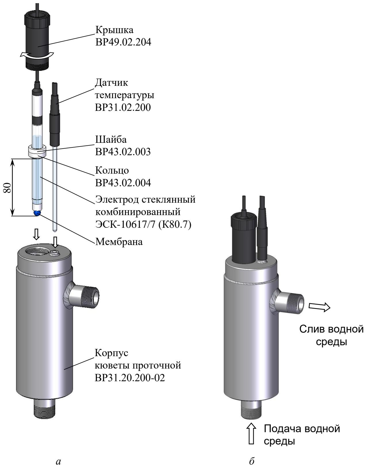
Рисунок 2.10 – Установка электрода стеклянного комбинированного и датчика температуры (на примере исполнения кюветы проточной BP31.20.200-02)
