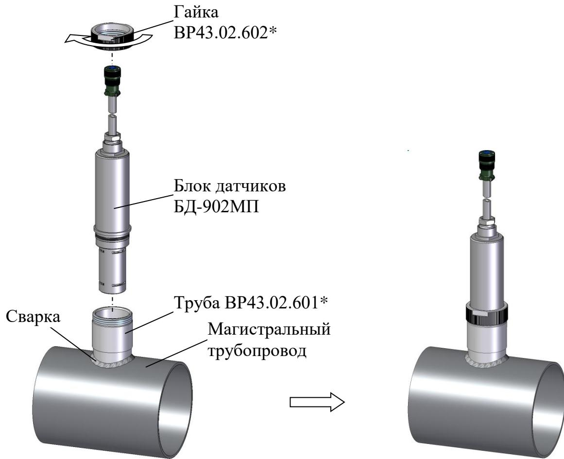
*a – Установка блока датчиков БД-902МП в магистральный трубопровод*
