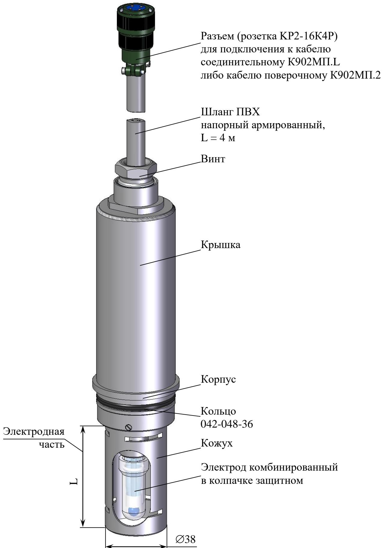
Рисунок 1.10 – Блок датчиков БД-902МП (вид с местным разрезом)
