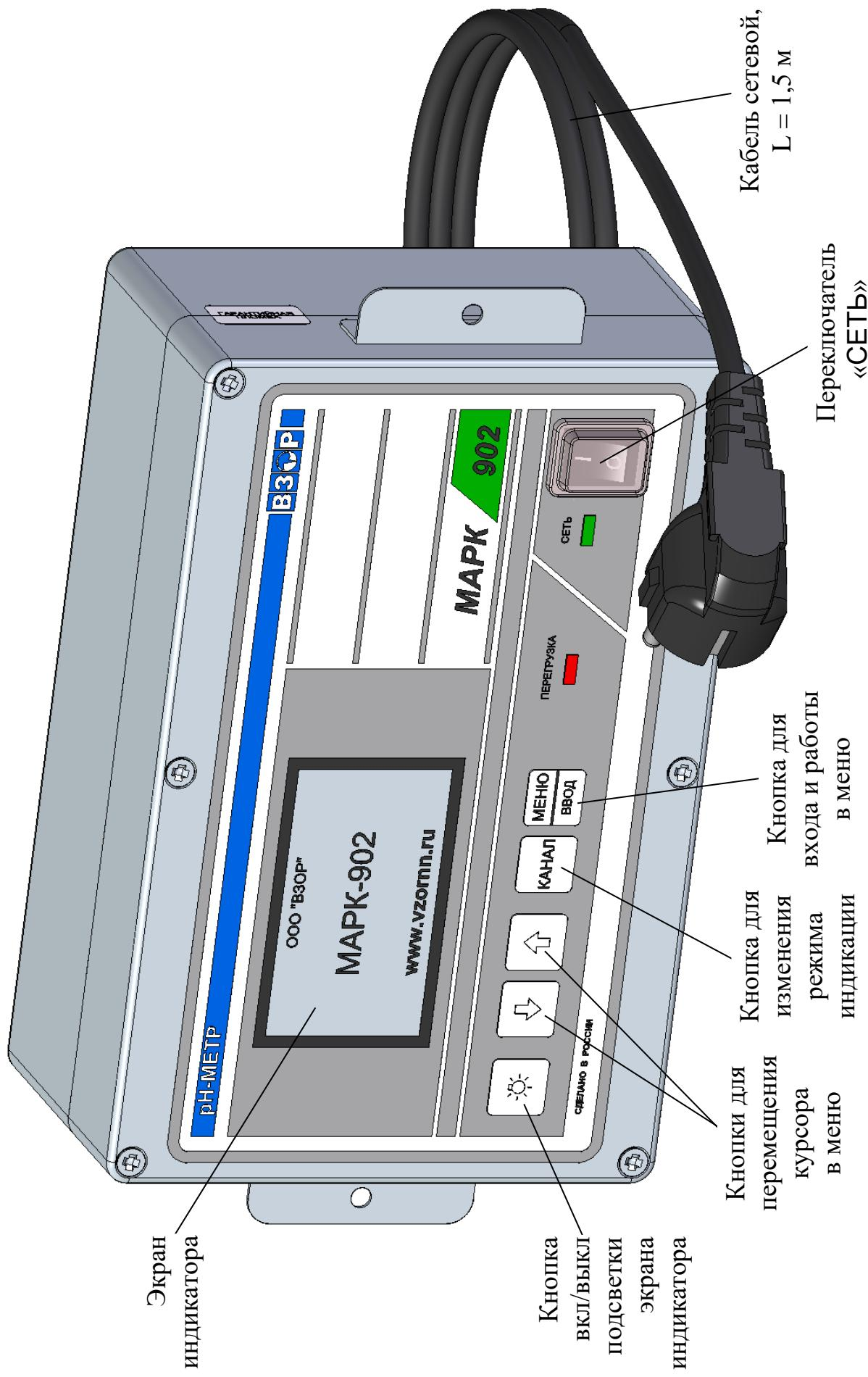
Рисунок 1.4 – Блок преобразовательный щитового исполнения (вид спереди)
