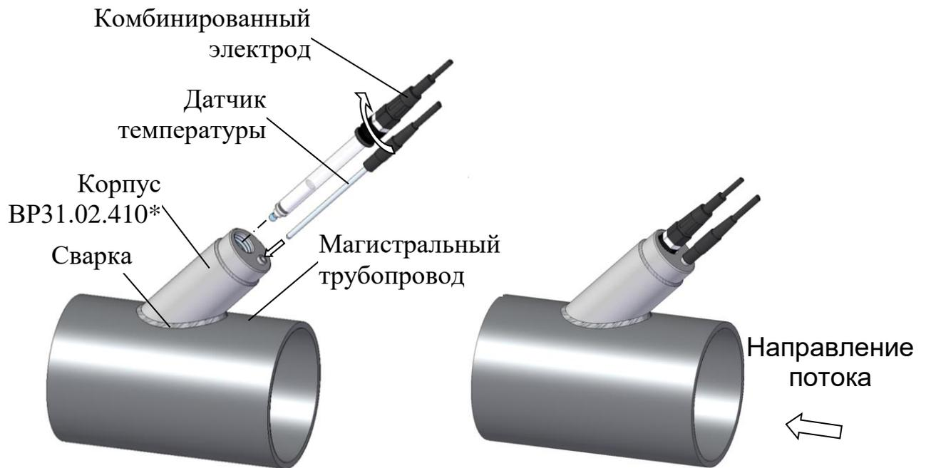
*а – Установка комбинированного электрода и датчика температуры в магистральный трубопровод*
