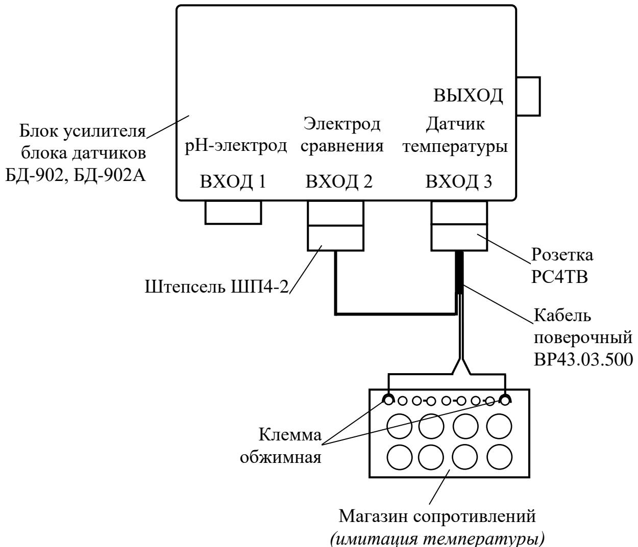
Рисунок Д.3 – Схема подключения кабеля поверочного BP43.03.500
