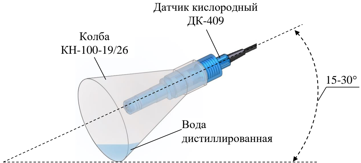
Рисунок 2.8 – Градуировка датчика ДК-409
