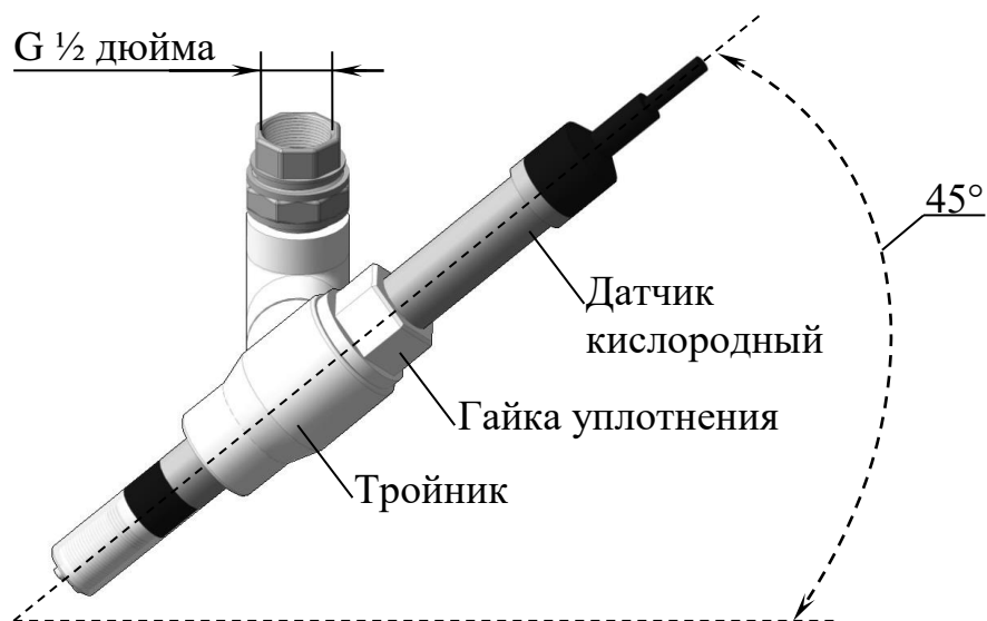
Рисунок 2.11 – Держатель датчика с установленным датчиком кислородным
