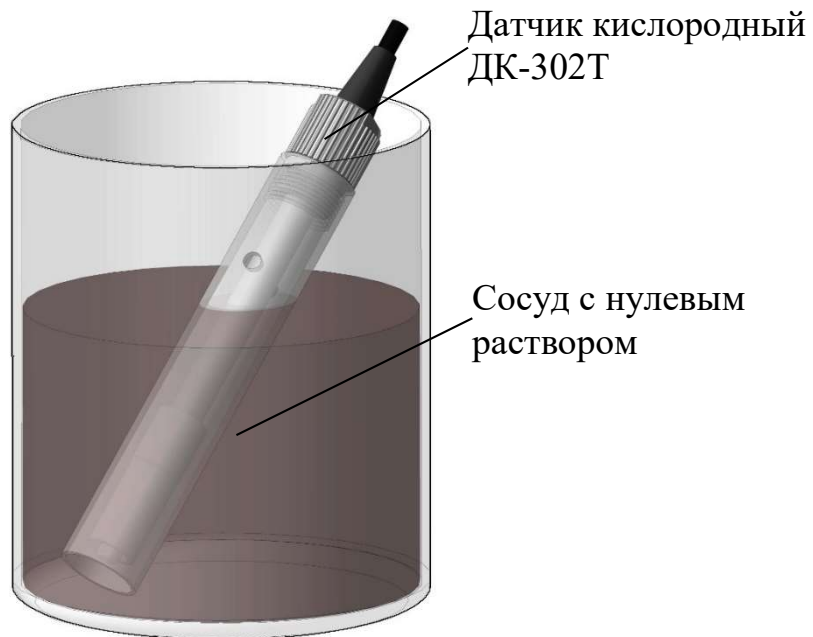
Рисунок 2.3 – Проверка показаний в «нулевом» растворе
