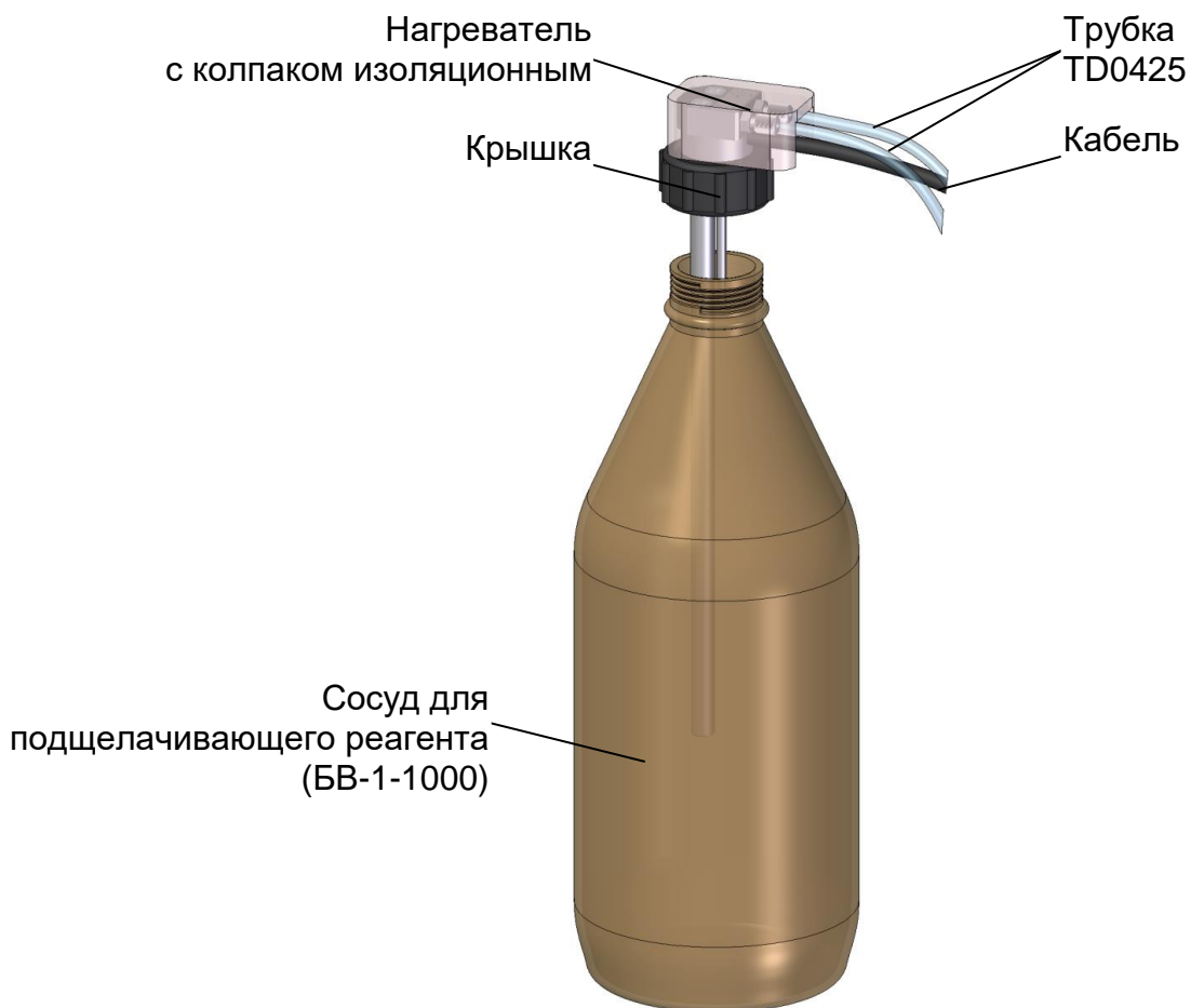
Рисунок 2.13 – Заливка подщелачивающего реагента в сосуд гидропанели ГП-1002Т
