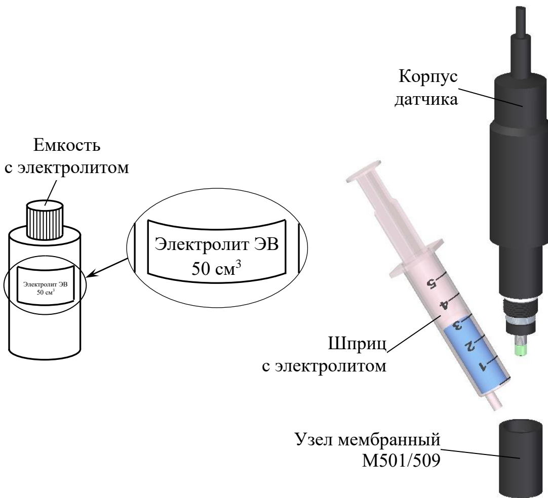
Рисунок 2.7 – Заливка (добавление) электролита
