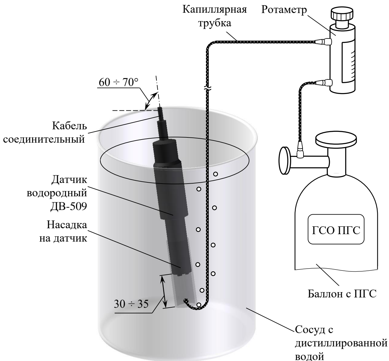
Рисунок 2.34 – Градуировка анализатора по ГСО-ПГС
