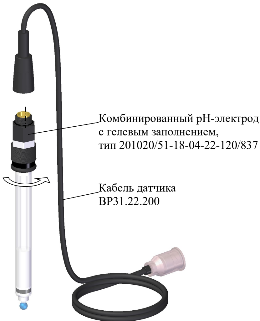
Рисунок 2.3 – Подсоединение кабеля датчика к электроду
