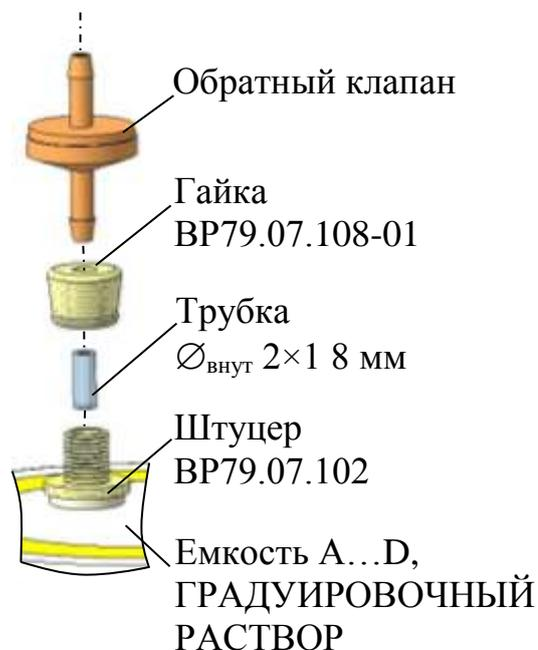
Рисунок 3.5 – Расположение трубки  $\text{Ø}_{\text{внут}} 2 \times 1$
