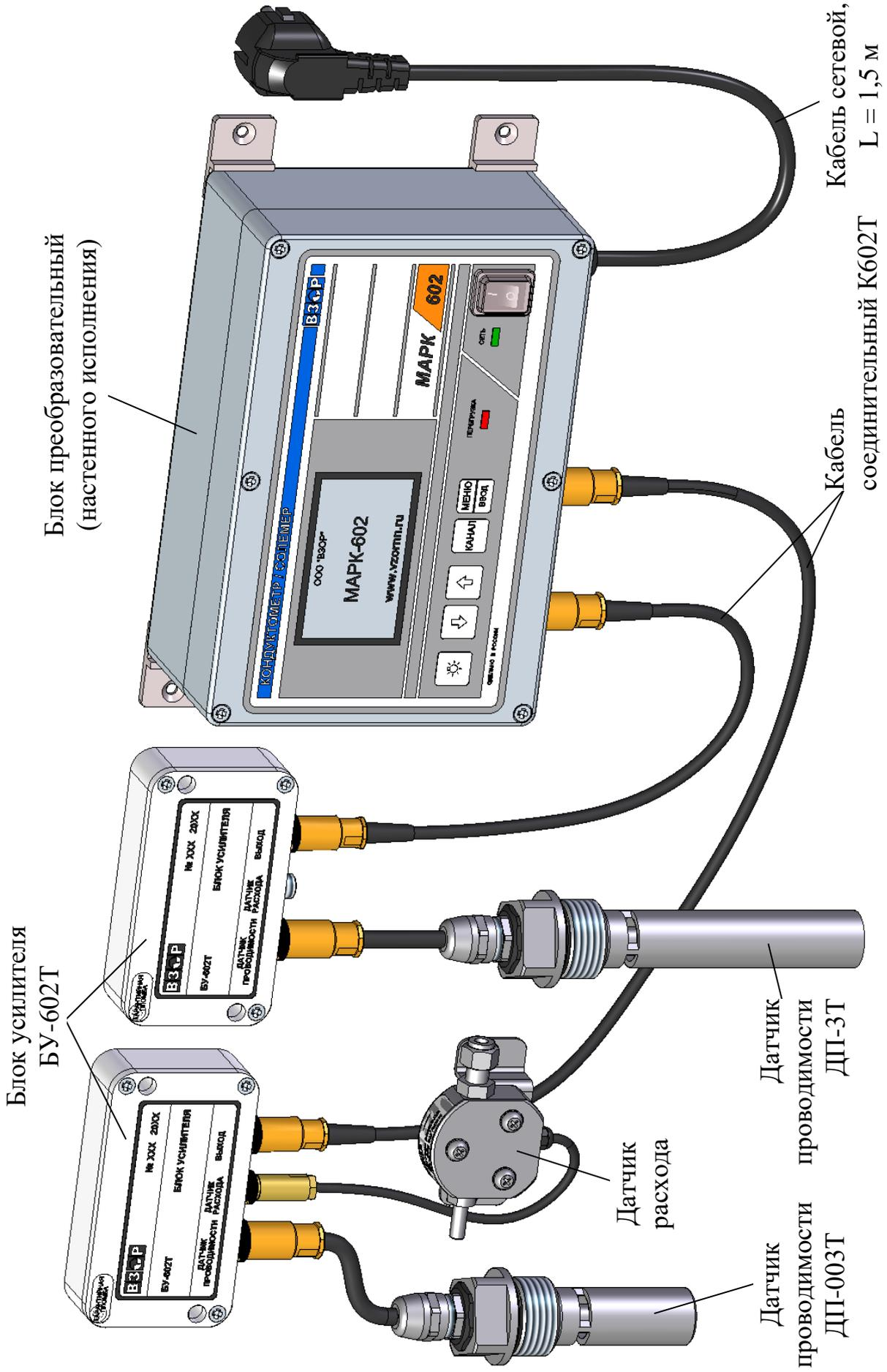
Рисунок 1.1 – Кондуктометр-солемер МАРК-602Т/1
