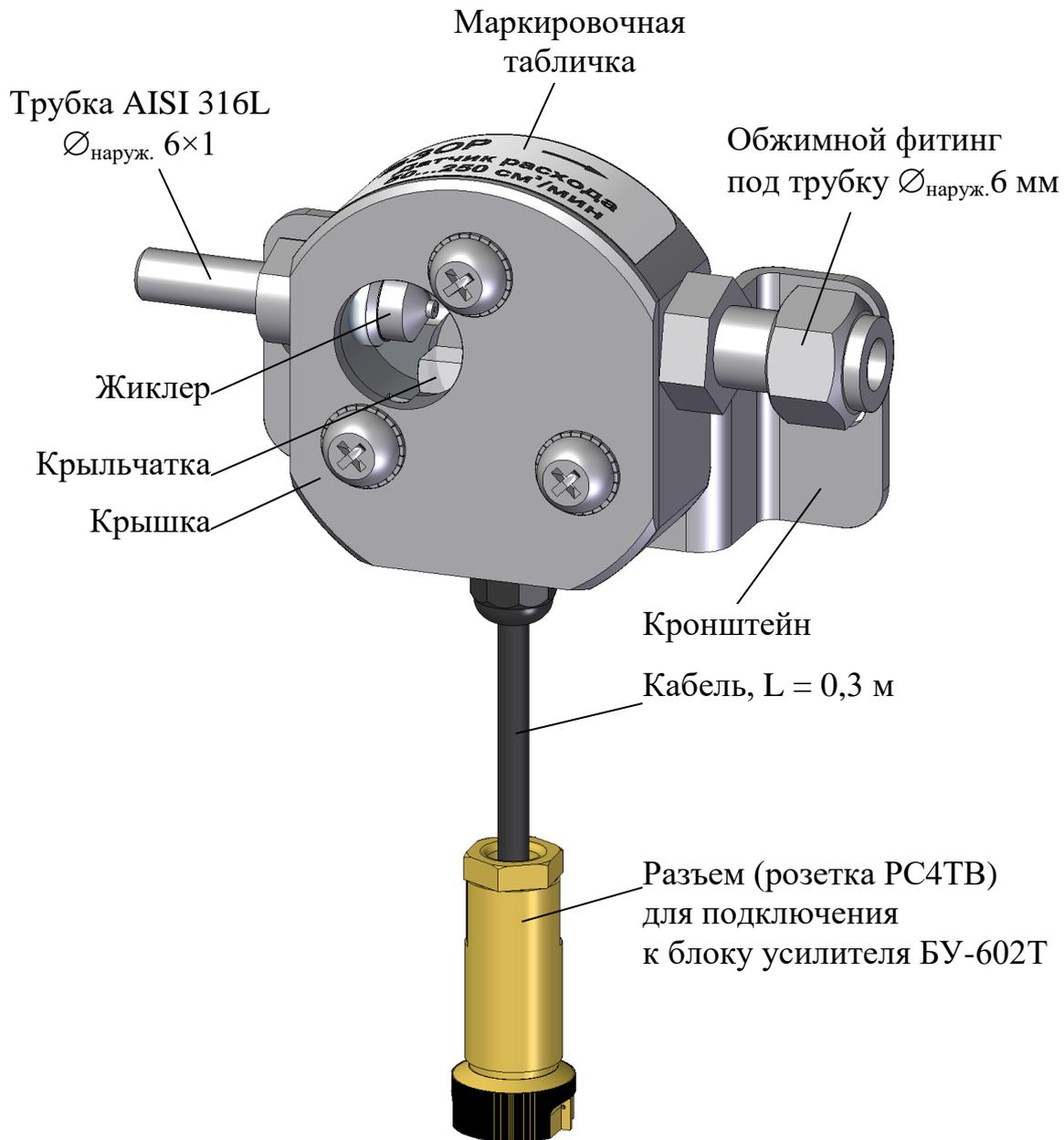
Рисунок 1.8 – Датчик расхода (вид с разрезом)
