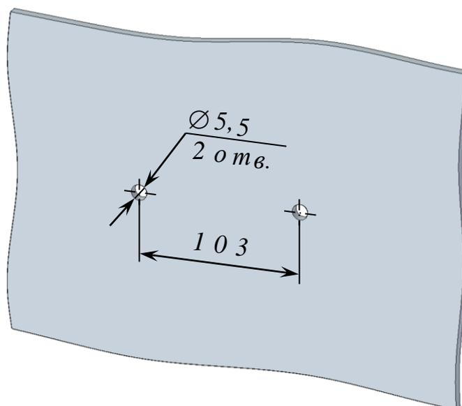
Рисунок 2.14 – Расположение и размер отверстий для крепления датчика расхода на панели монтажной ВР69.10.000
