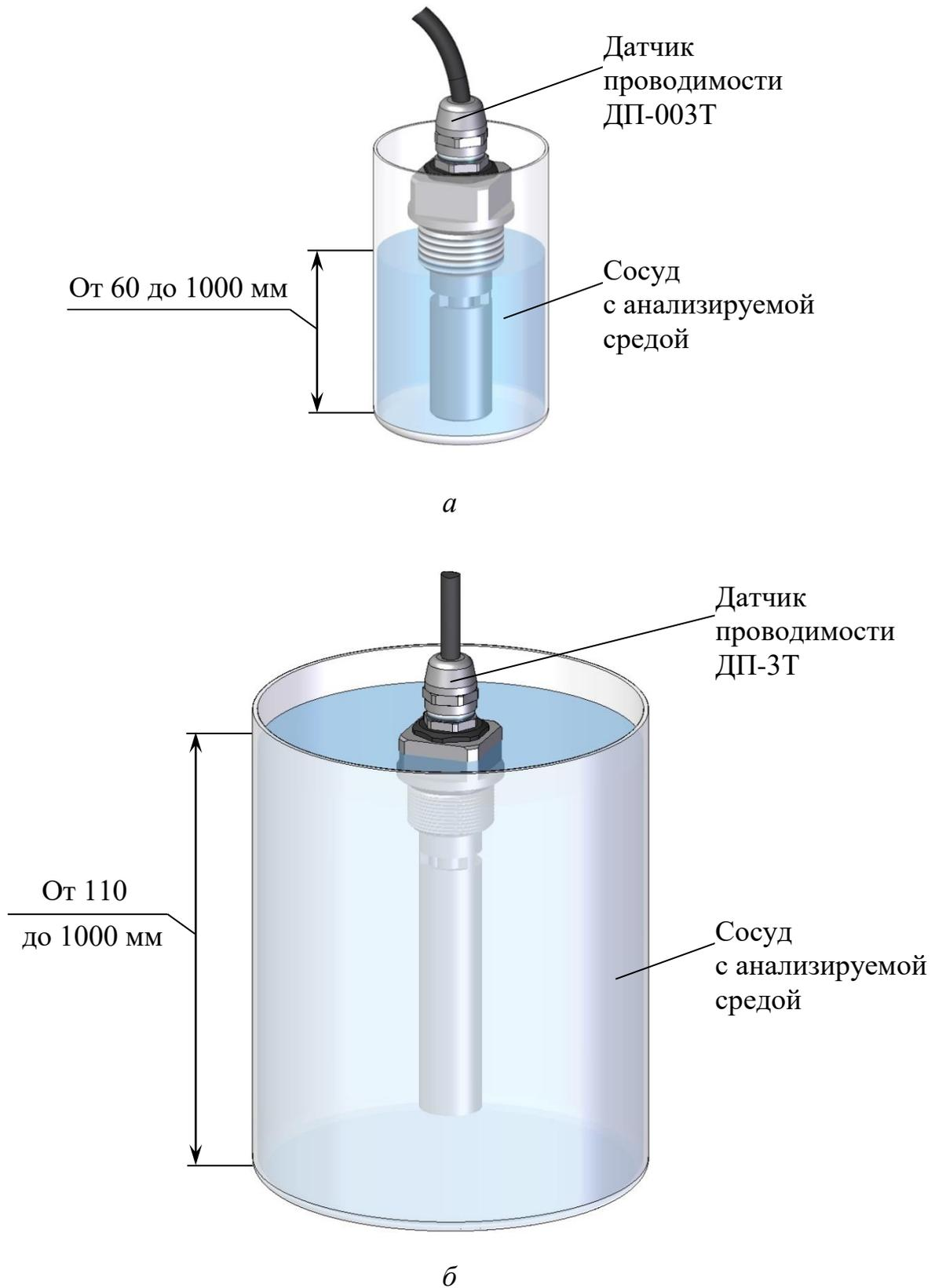
Рисунок 2.9 – Пример расположения датчика проводимости в сосуде с анализируемой средой при погружном способе измерений
