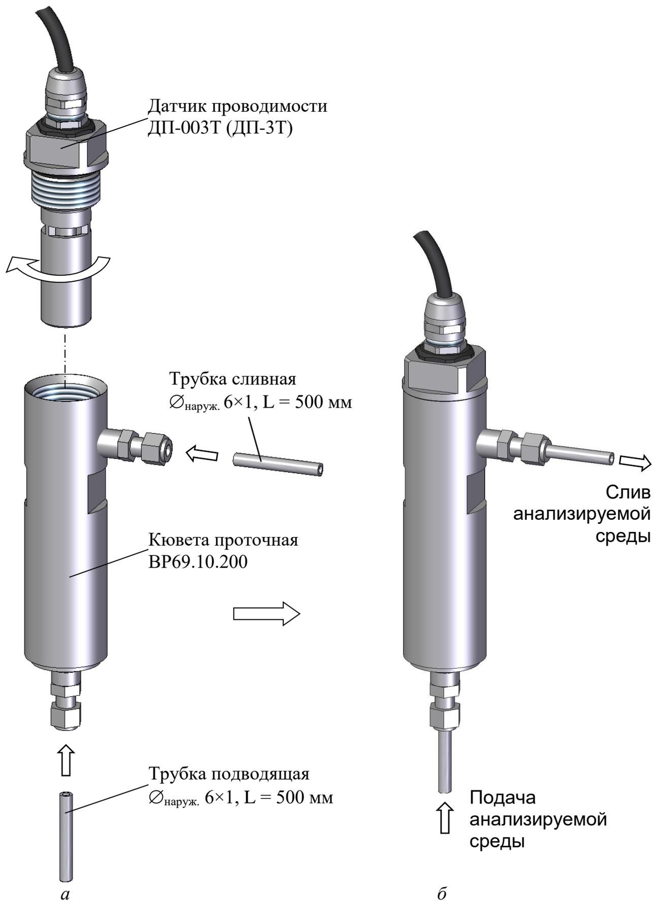
Рисунок 2.11 – Расположение датчика проводимости ДП-003Т в кювете проточной ВР69.10.200 при проточном способе измерений
