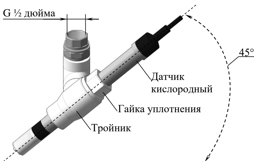
Рисунок 2.9 – Держатель датчика с установленным датчиком кислородным
