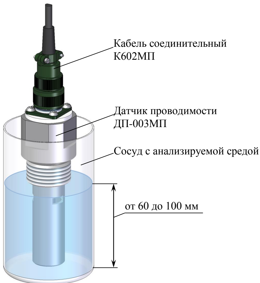
Рисунок 2.8 – Расположение датчика проводимости ДП-003МП в сосуде
