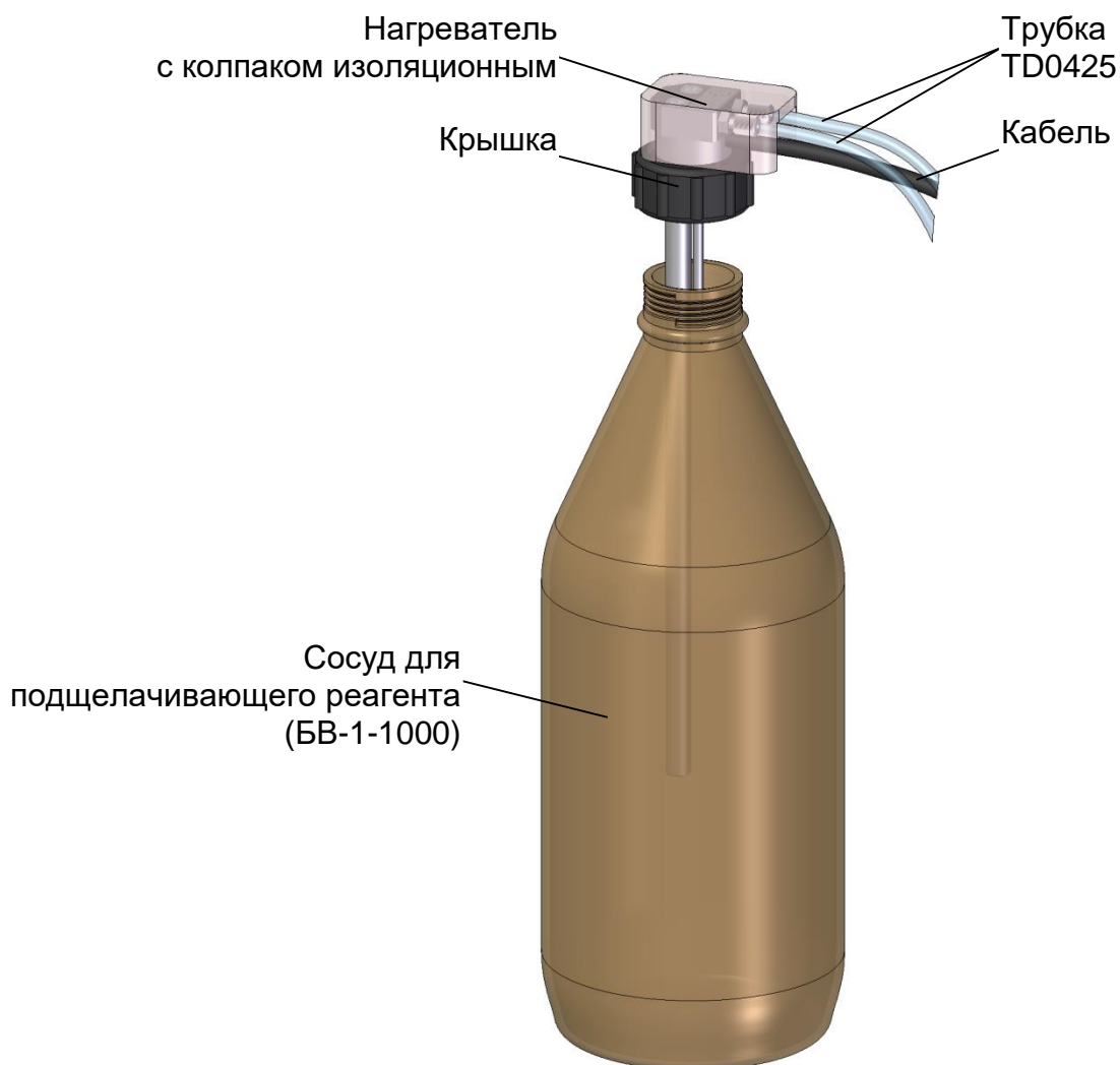
Рисунок 2.13 – Заливка подщелачивающего реагента в сосуд гидропанели ГП-1002Т
