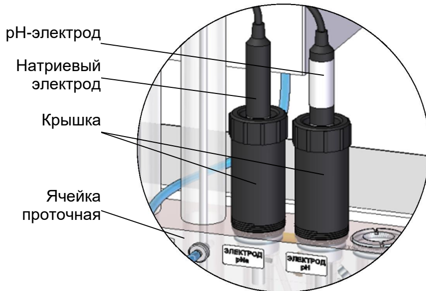
Рисунок 2.9 – Расположение натриевого и pH-электродов в ячейке проточной (местный вид)
