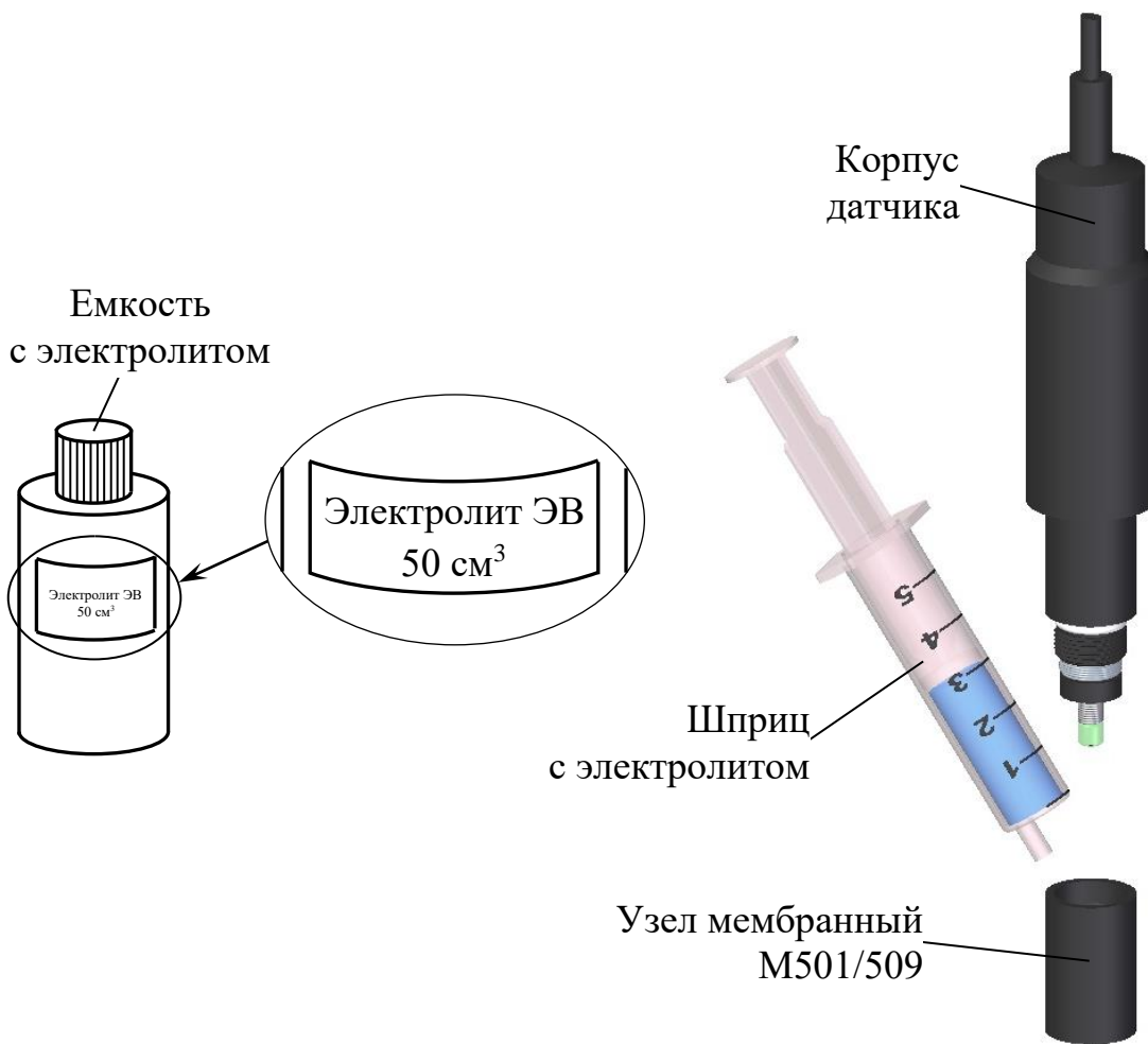
Рисунок 2.7 – Заливка (добавление) электролита
