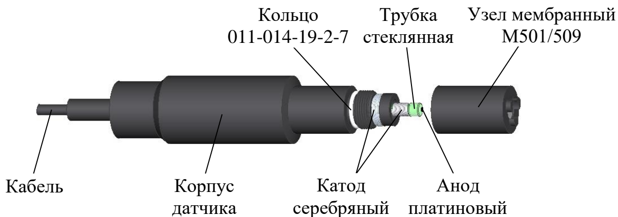
Рисунок 1.5 – Датчик водородный ДВ-509
