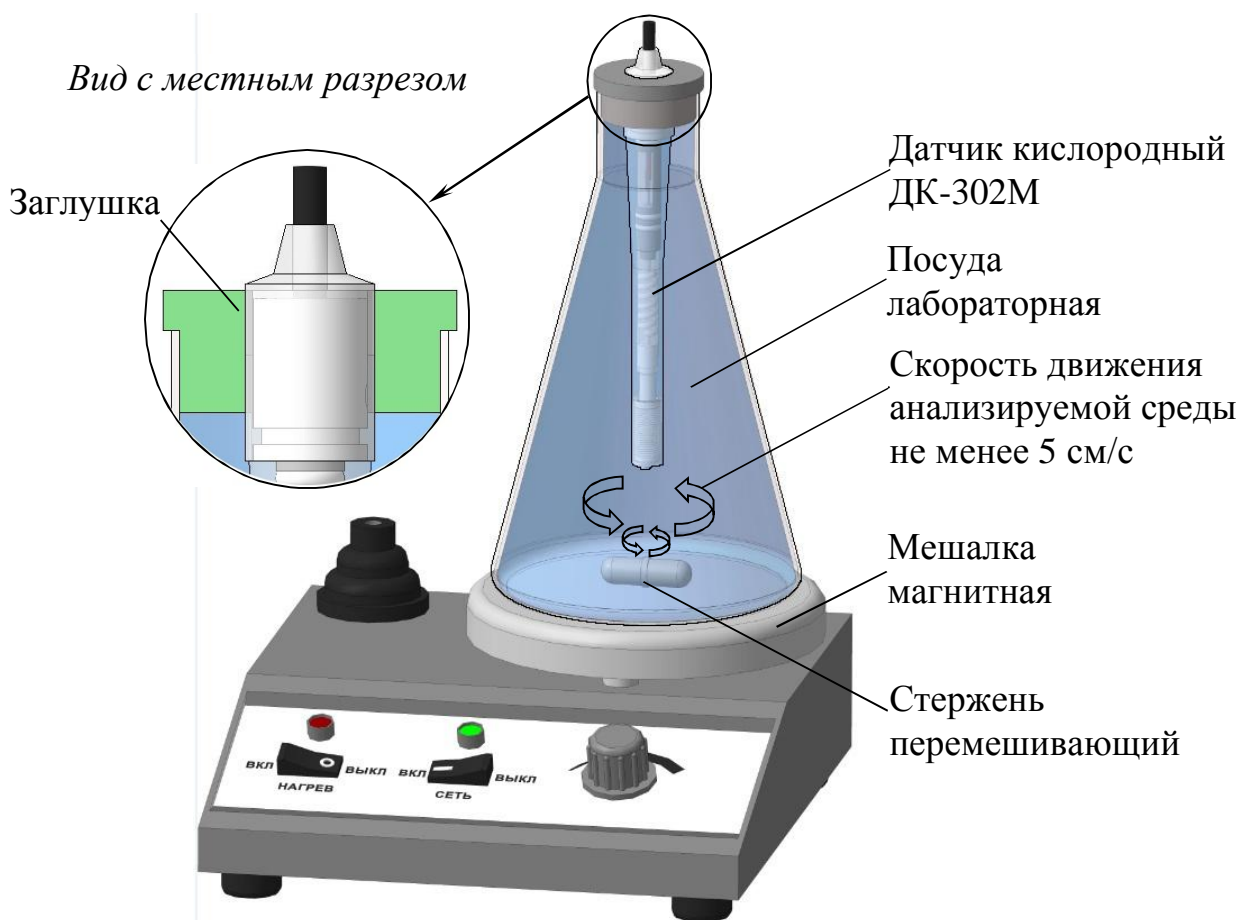
Рисунок 2.8 - Положение датчика в лабораторной посуде при измерении КРК (УНК)
