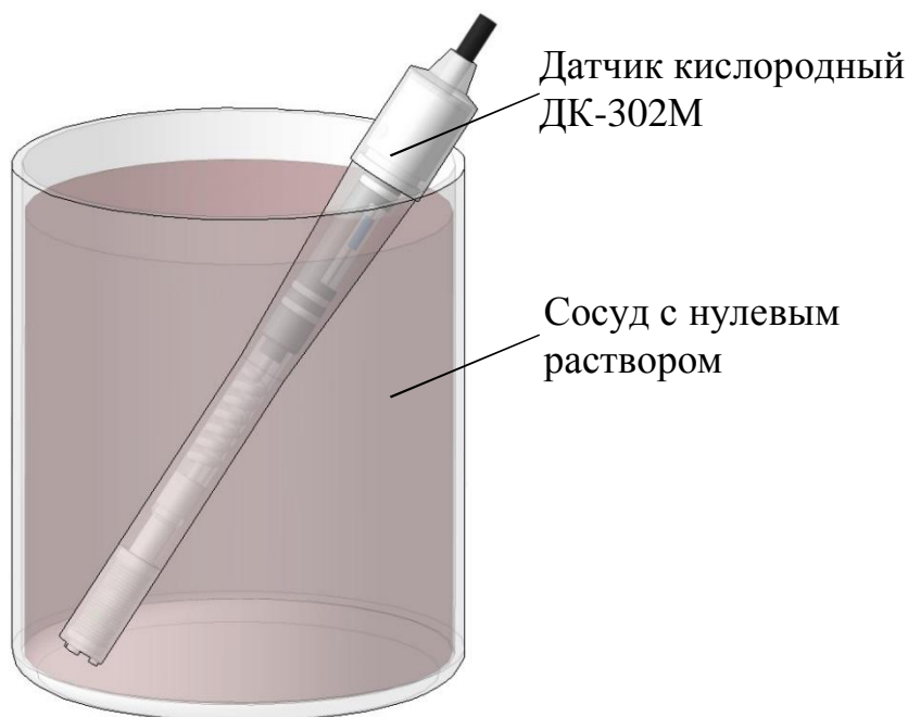
Рисунок 2.3 – Проверка показаний в «нулевом» растворе
