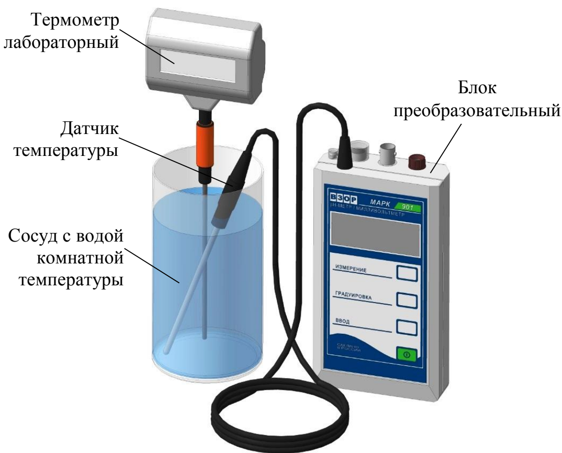
Рисунок 3.2 – Проверка показаний по температуре
