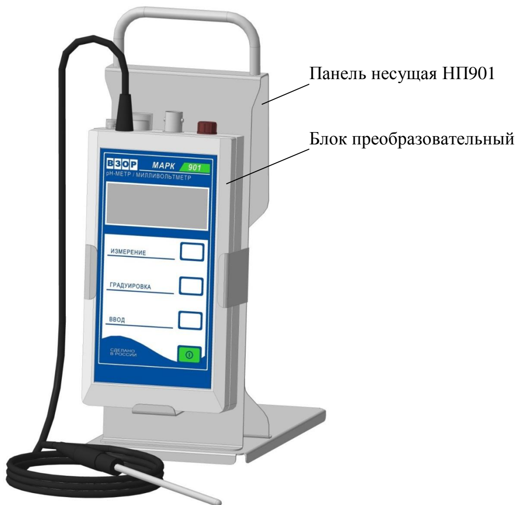
Рисунок 2.2 – Панель несущая НП901 с установленным блоком преобразовательным
