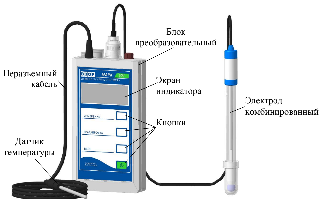
а) рН-метр/милливольтметр портативный МАРК-901
