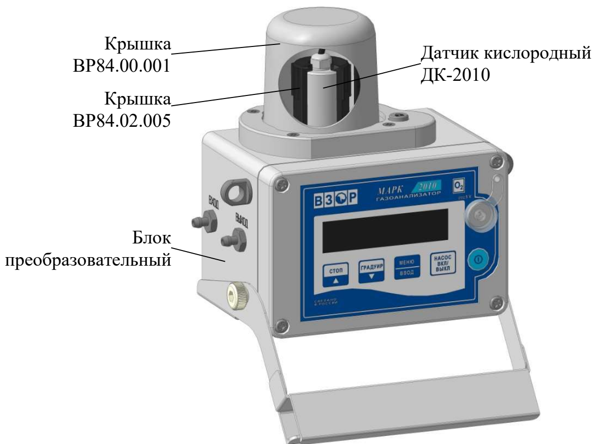
Рисунок 1.1 – Газоанализатор МАРК-2010 (вид с местным разрезом)
