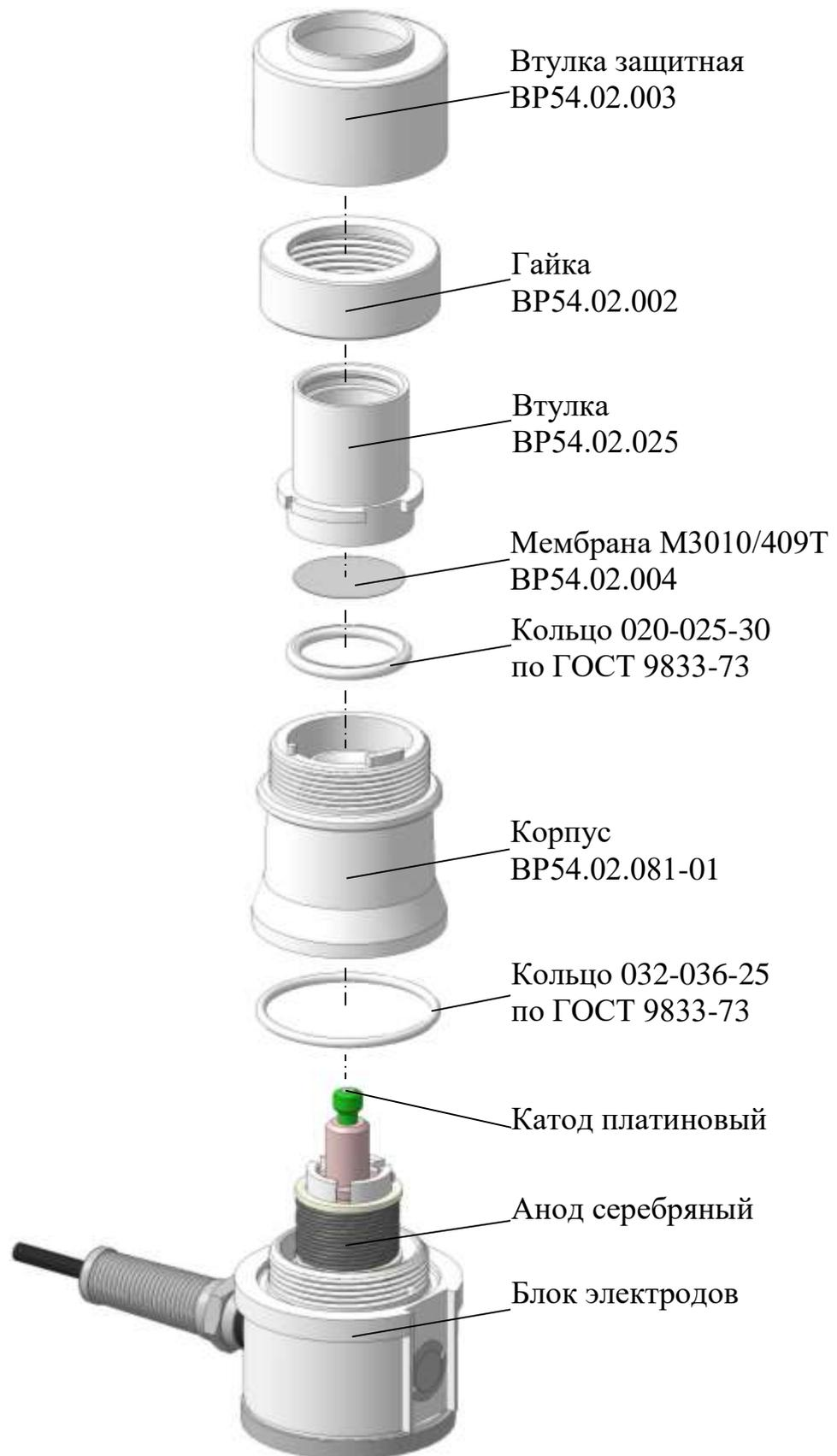
Рисунок 1.4 – Составные части датчика кислородного ДК-3010
