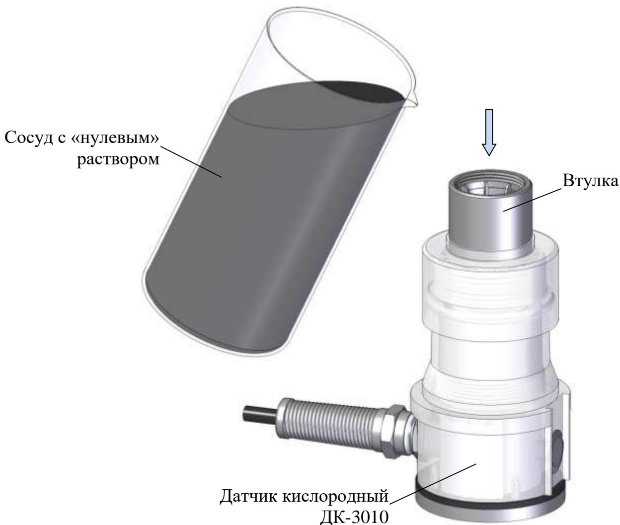
Рисунок 2.2 – Проверка показаний в «нулевом» растворе
