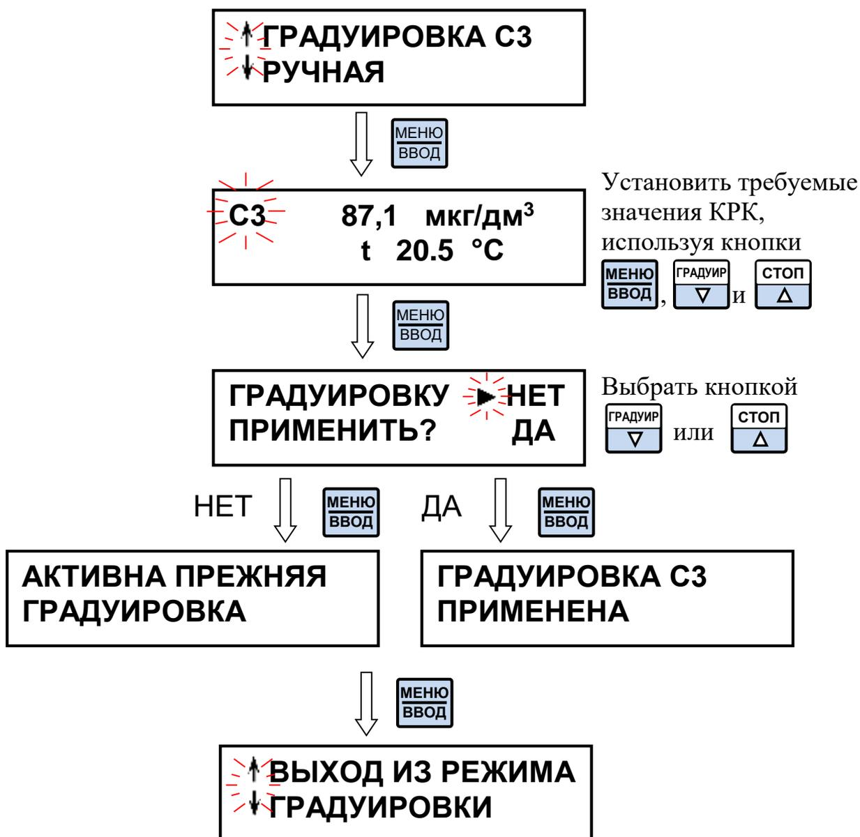
Рисунок 2.7 – Последовательность операций при проведении градуировки по эталонной кислородной среде с известным значением КРК
