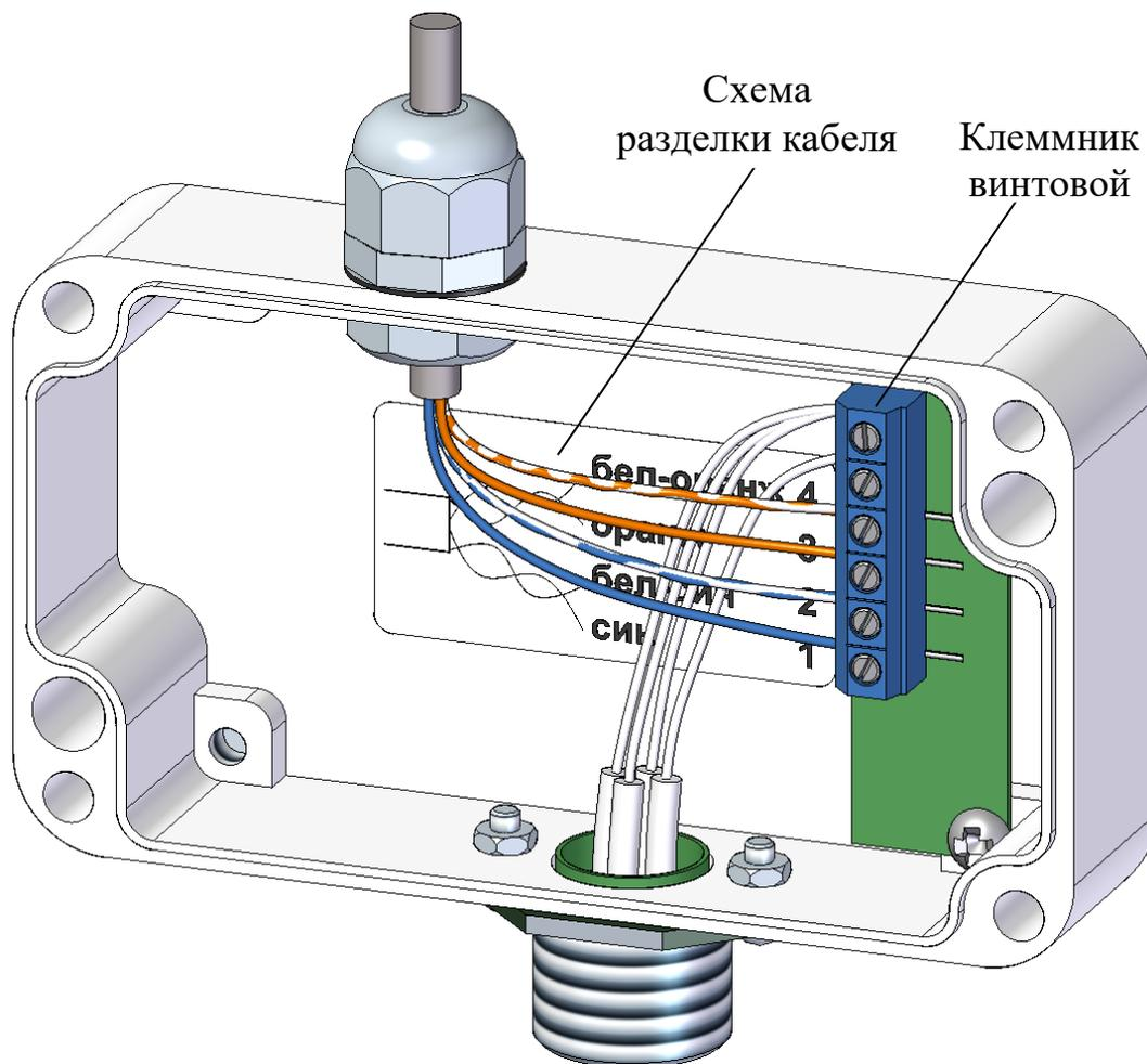
Рисунок 2.14 – Коробка клеммная (вид без передней панели)
