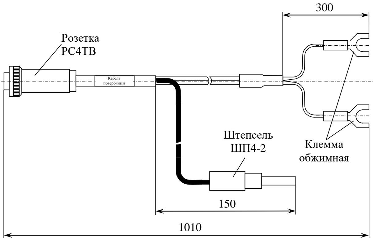
Рисунок Д.2 – Кабель поворачивый ВР43.03.500
