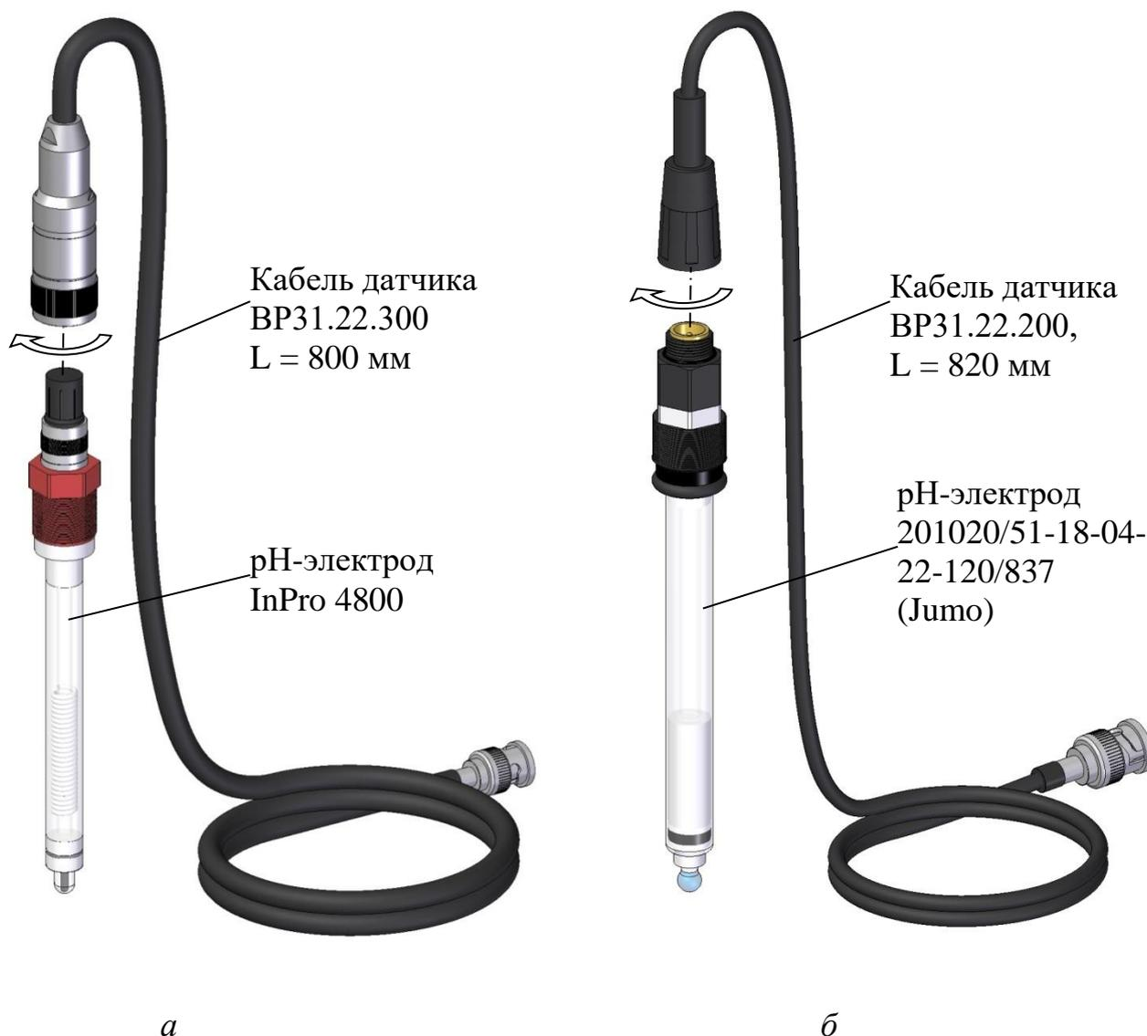
*Рисунок 1.9 – Подключение кабеля датчика к комбинированным рН-электродам*
