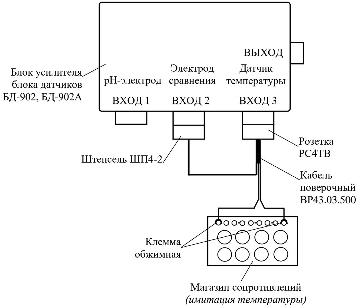
Рисунок Д.3 – Схема подключения кабеля поверочного ВР43.03.500
