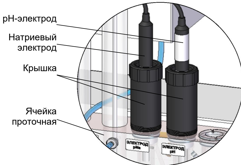
Рисунок 2.9 – Расположение натриевого и рН-электродов в ячейке проточной (местный вид)
