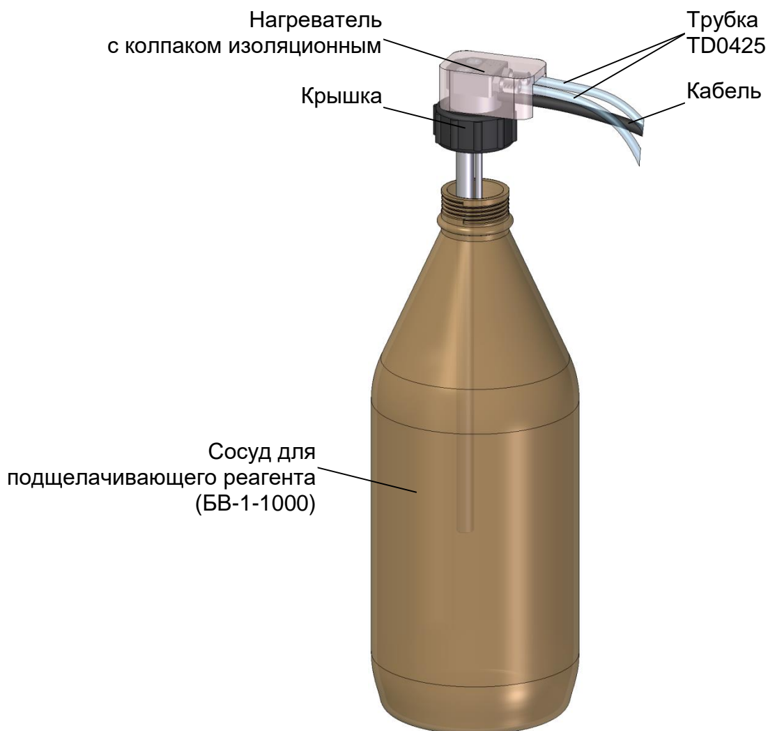
Рисунок 2.13 – Заливка подщелачивающего реагента в сосуд гидропанели ГП-1002Т
