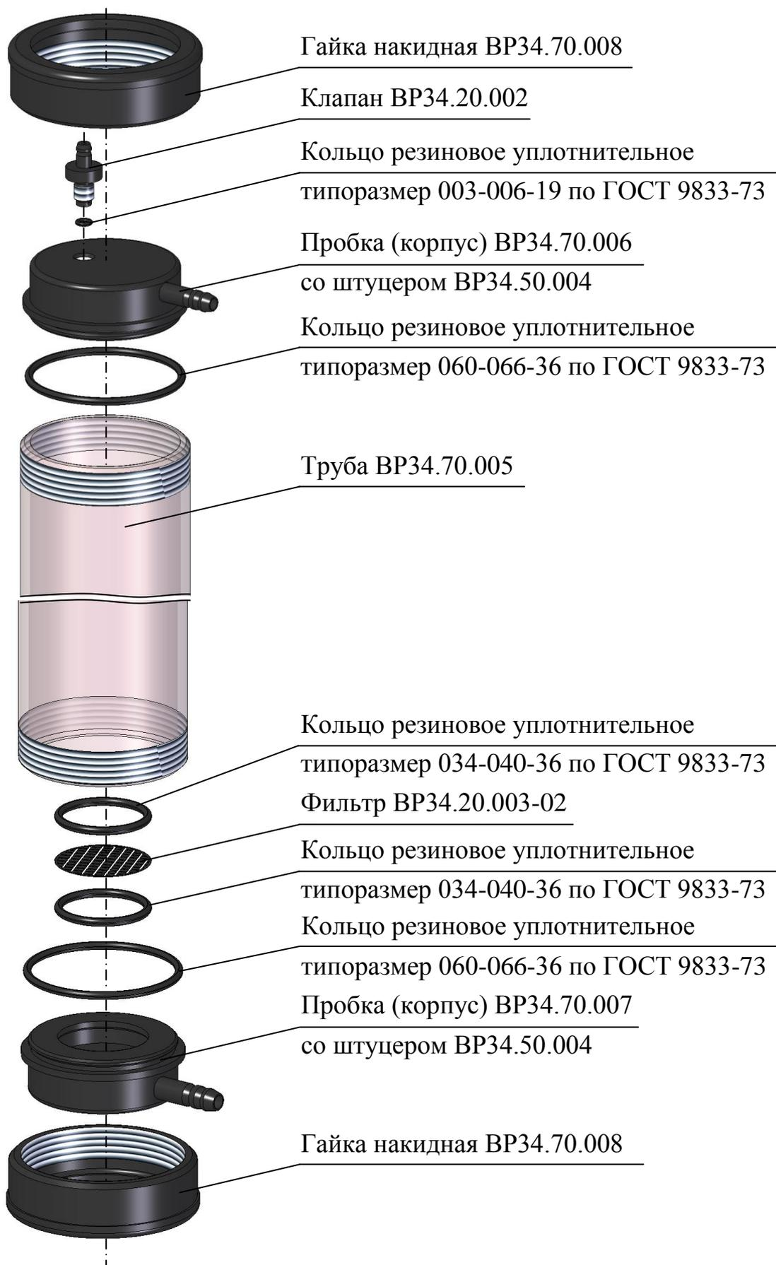
*Рисунок 4.1 – Номенклатура составных частей колонки*
