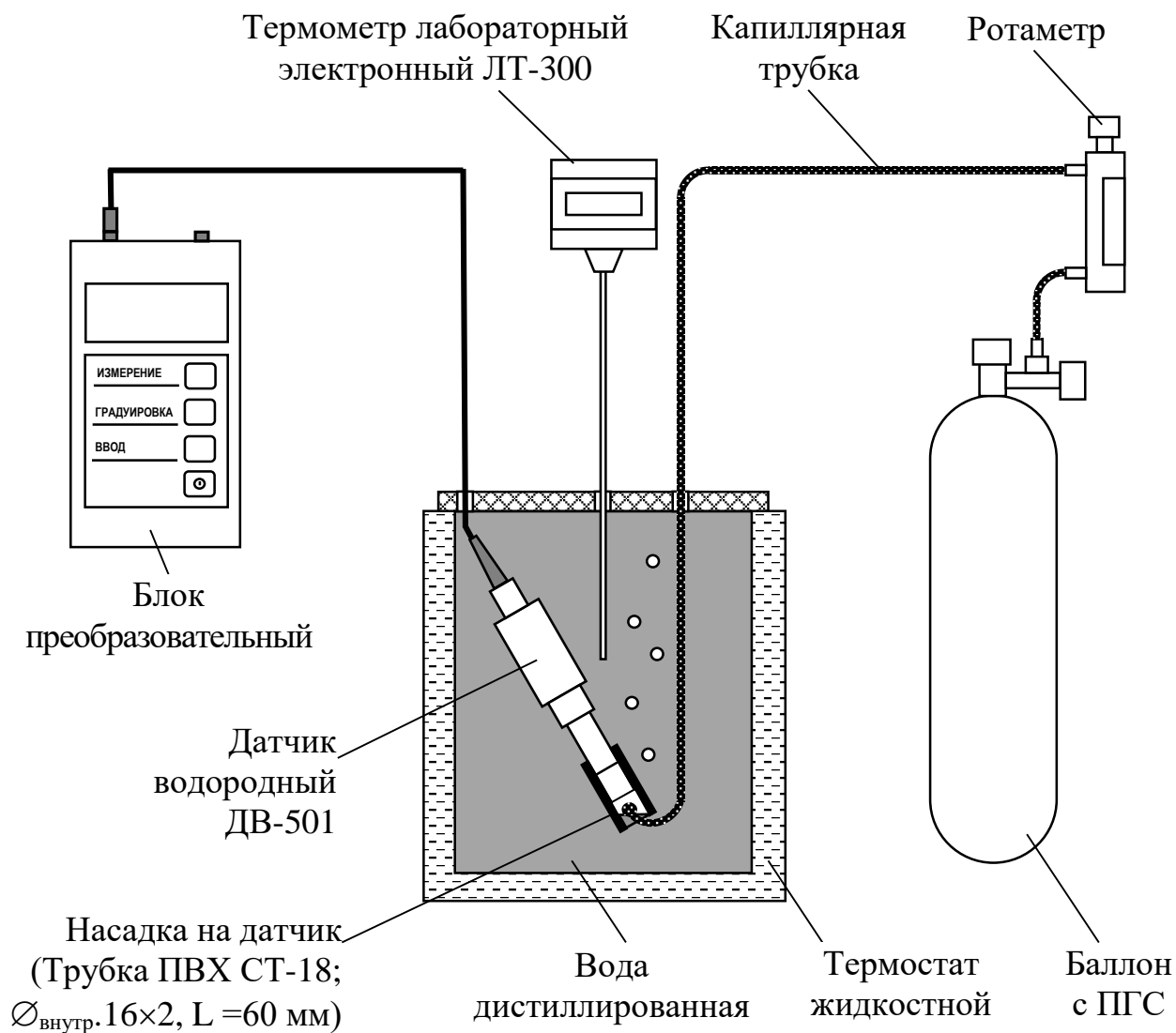
Рисунок А.10.2 – Установка для определения основной абсолютной погрешности анализатора при измерении КРВ и объемной доли водорода
