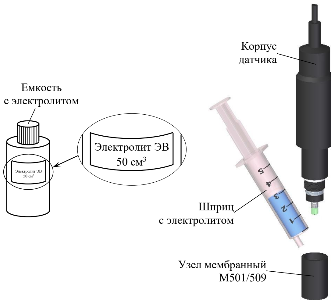
Рисунок 2.2 – Заливка (добавление) электролита
