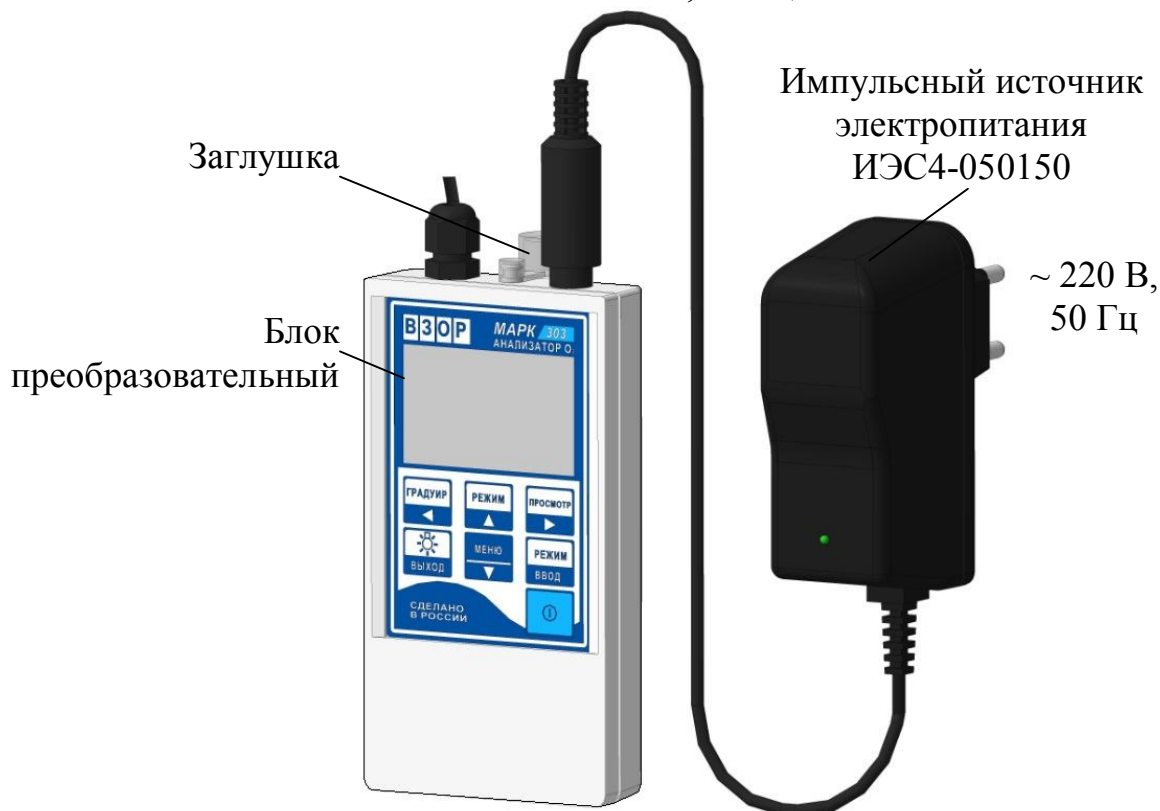
Рисунок 3.2 – Зарядка аккумуляторных батарей
