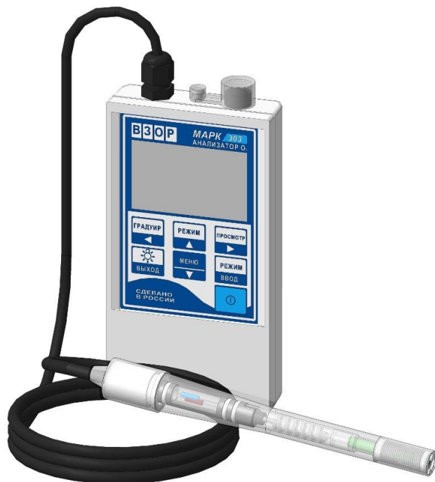
Рисунок 1.1 – Анализатор растворенного кислорода МАРК-303М
