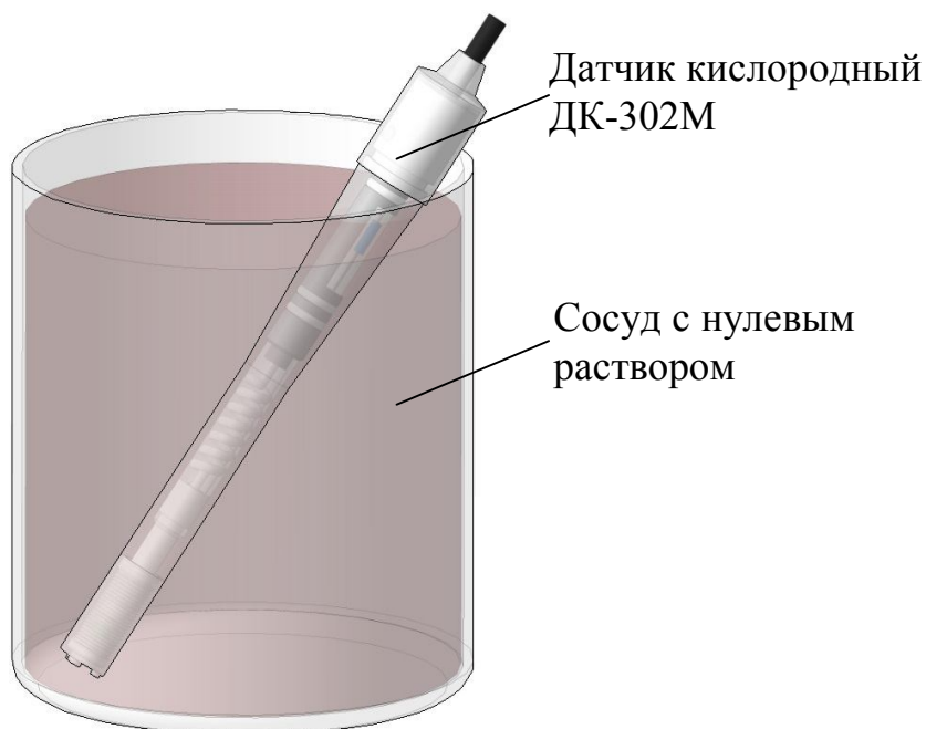
Рисунок 2.11 – Проверка показаний в «нулевом» растворе
