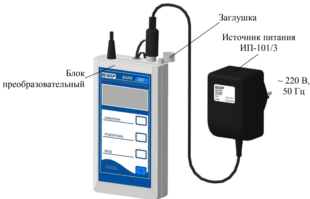
Рисунок 3.2 – Зарядка аккумуляторных батарей
