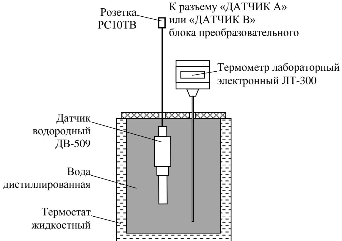
В термостате устанавливают датчик и термометр лабораторный электронный ЛТ-300. Датчик погружают в воду полностью.
