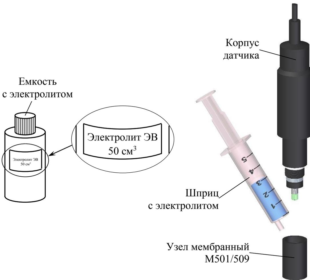
Рисунок 2.7 – Заливка (добавление) электролита
