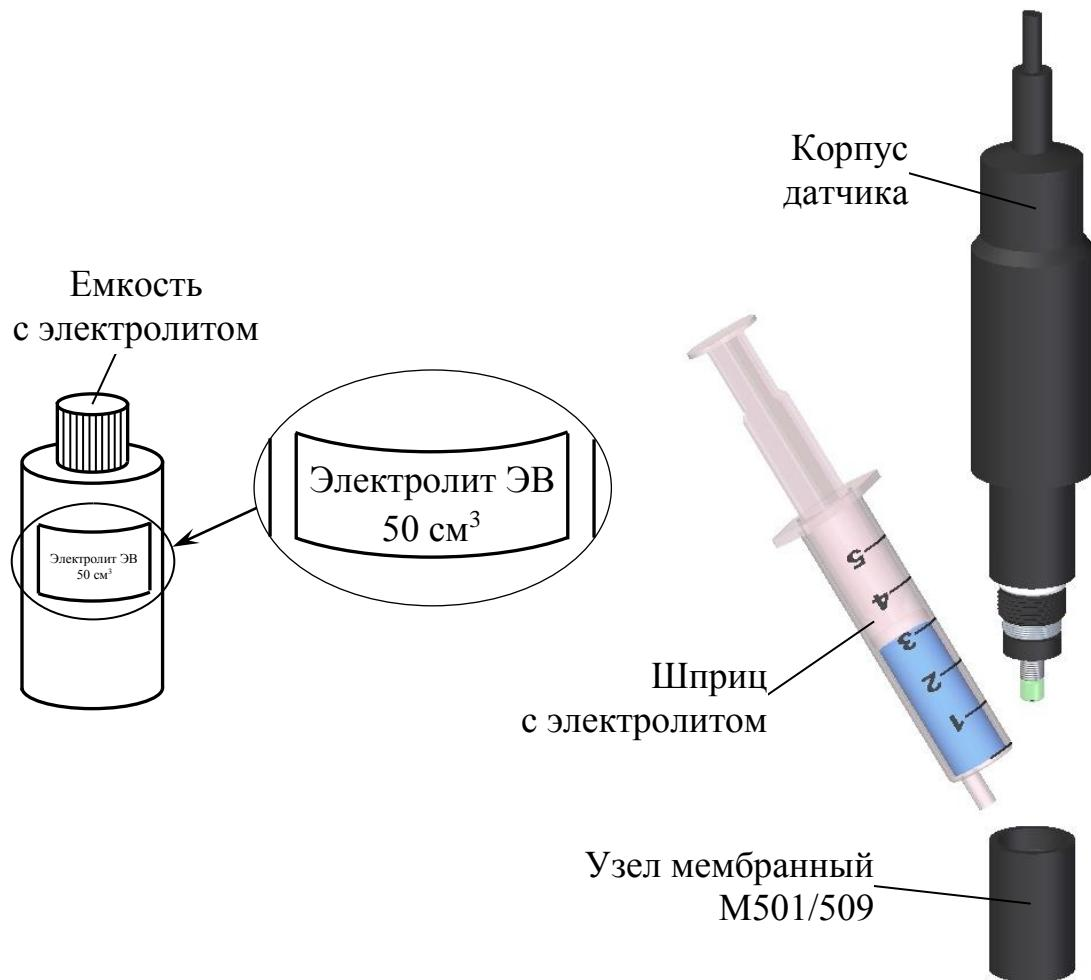
*Рисунок 2.7 – Заливка (добавление) электролита*
