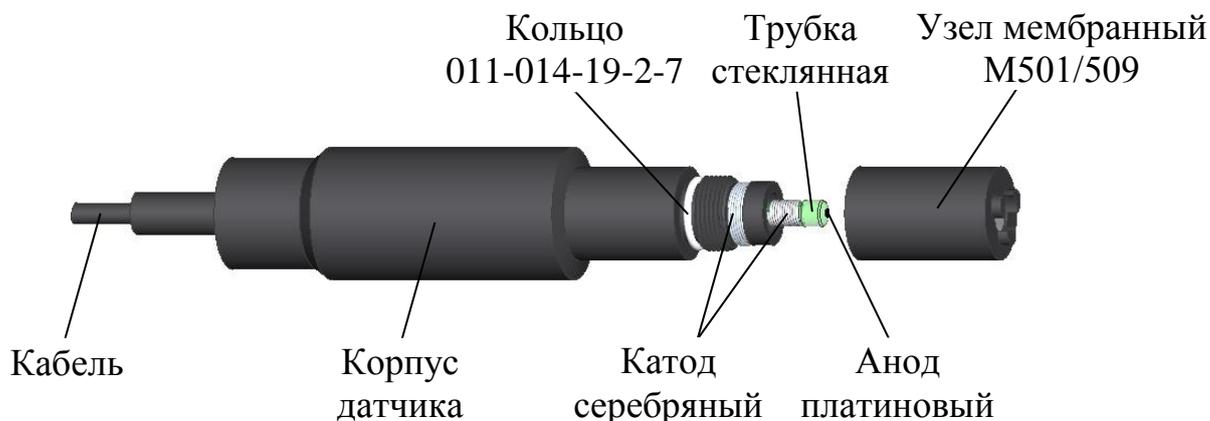
Рисунок 1.5 – Датчик водородный ДВ-501
