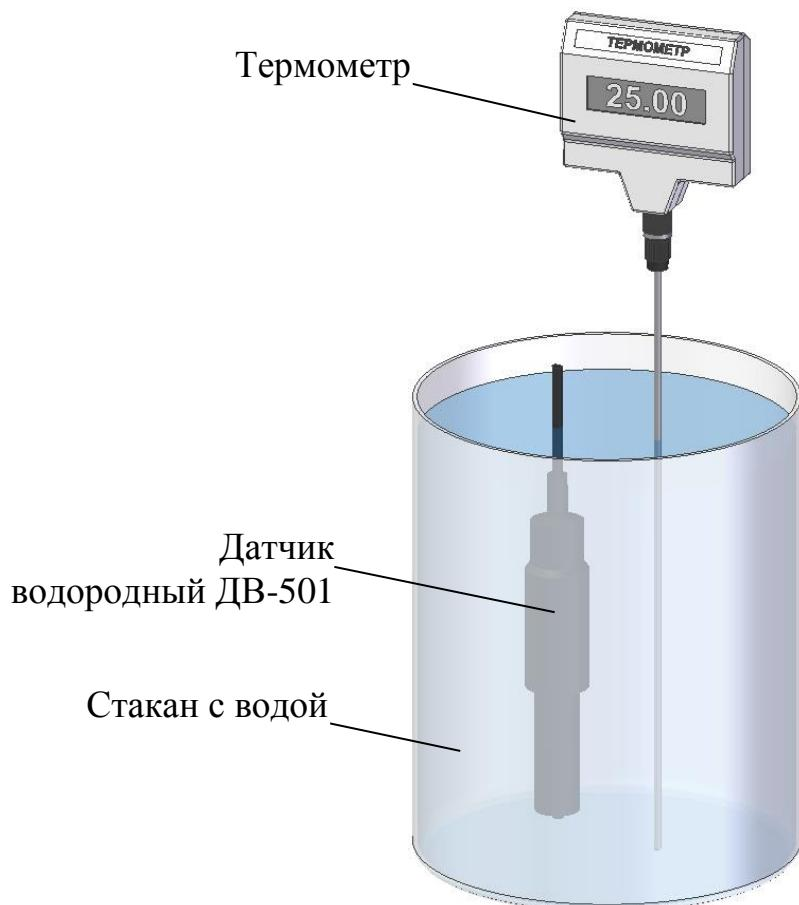
*Рисунок 3.2 – Проверка показаний по температуре*
