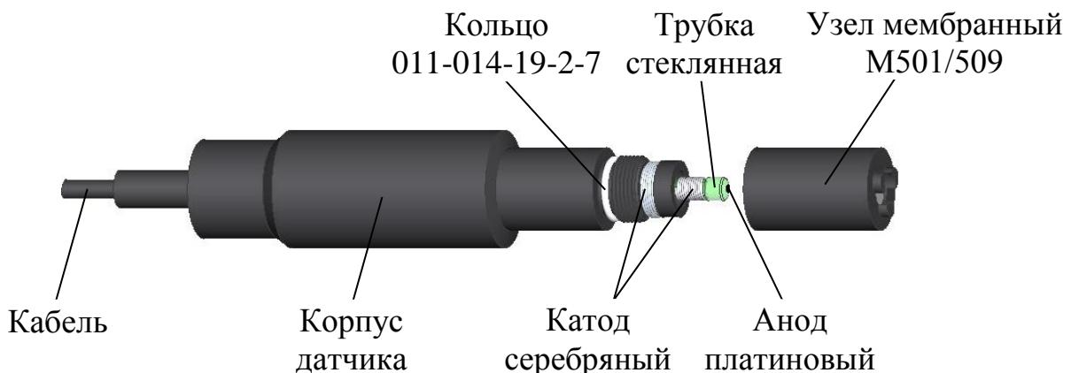
*Рисунок 1.5 – Датчик водородный ДВ-501*
