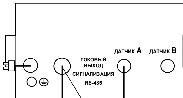
Блок преобразовательный щитового исполнения (вид сзади)
