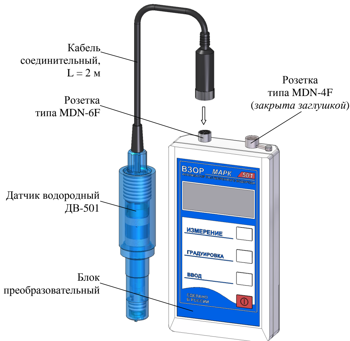
Рисунок 2.3 – Подключение датчика водородного ДВ-501 к блоку преобразовательному
